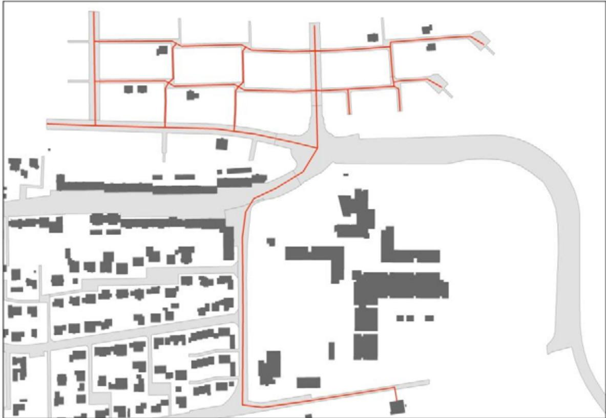
Abbildung 7-24 schematisch Darstellung bestehendes Wärmenetz Neubaugebiet Bubenstück in Bingen-Büdesheim
