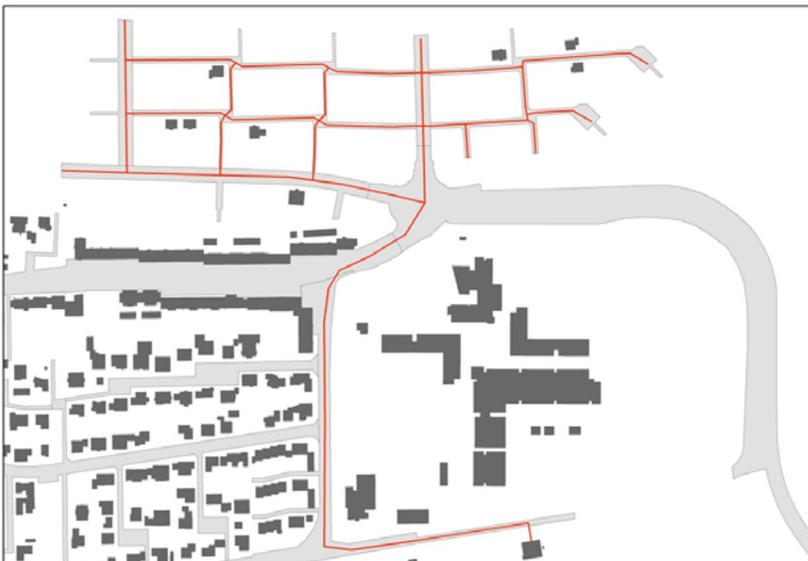
Abbildung 4-1 Schematische Darstellung des Nahwärmenetzes im Neubaugebiet Bubenstück – Bingen/Budesheim
