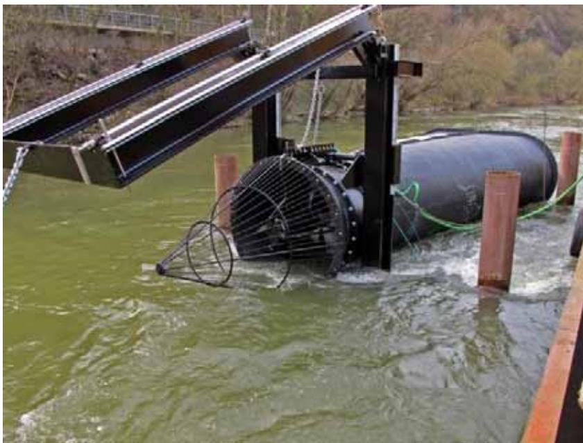
Abbildung 6-16 Flussturbine der KSB AG
