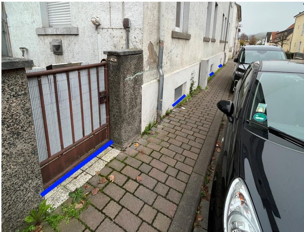
Abbildung 59: Notfließweg „Matthias-Erzberger-Straße“ mit Objektschutzmaßnahmen (blau)
