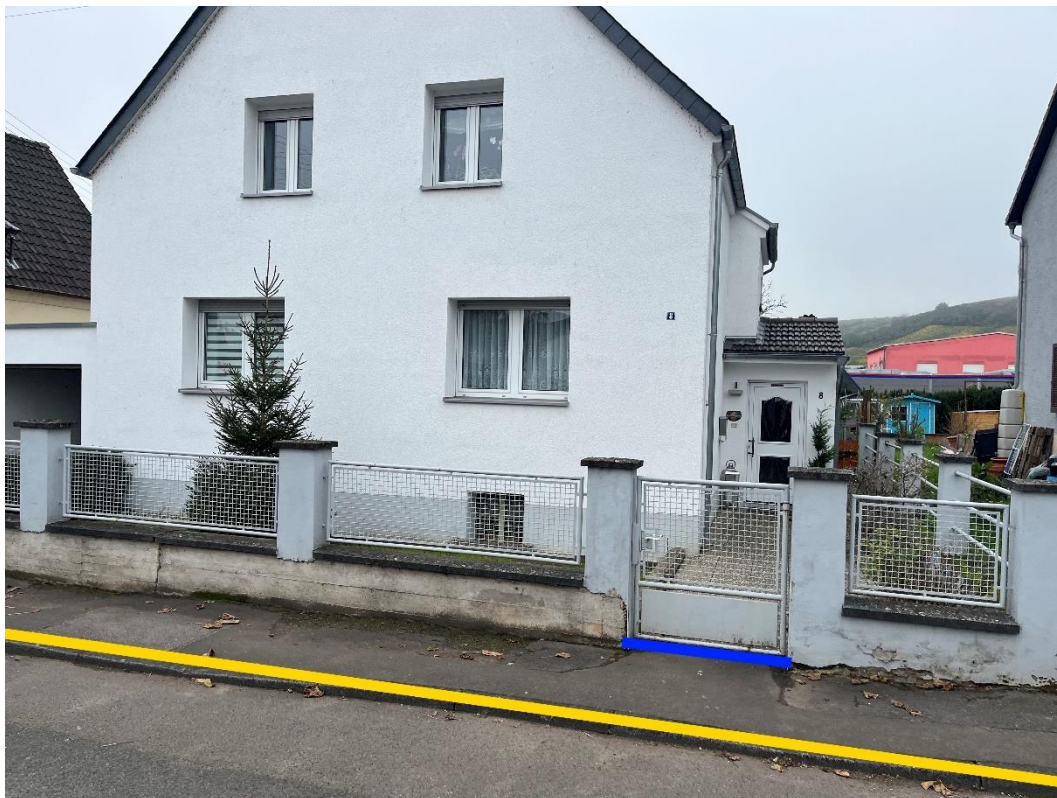
Abbildung 120: Notfließweg „Jakob-Ebermann-Straße“ mit Objektschutzmaßnahmen (blau) und Bordanlagen (gelb)
