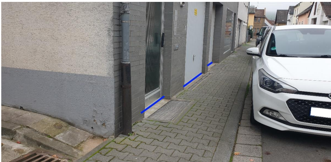
Abbildung 91: Notfließweg „Wilhelmstraße“ mit Objektschutzmaßnahmen (blau)
