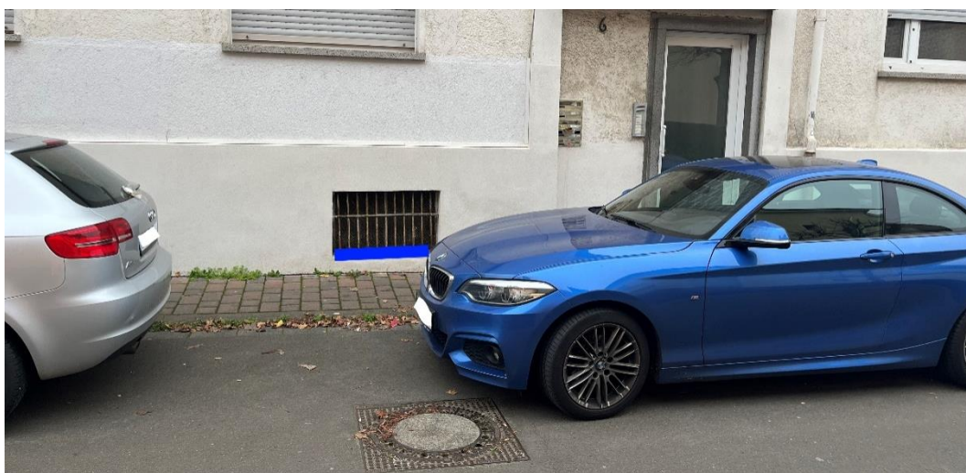
Abbildung 62: Notfließweg „Matthias-Erzberger-Straße“ mit Objektschutzmaßnahmen (blau)
