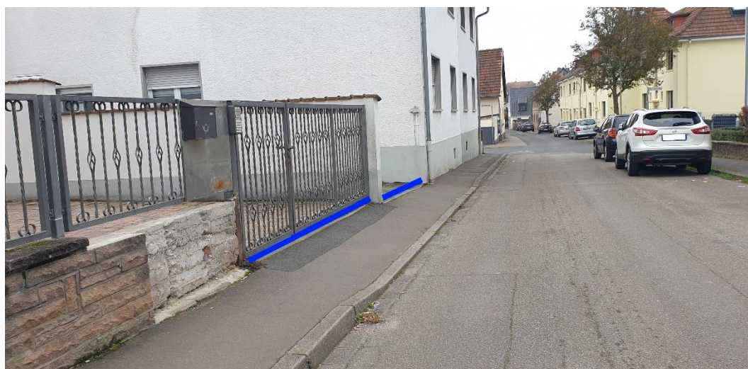
Abbildung 12: Notfließweg „Osterbergstraße“ mit Objektschutzmaßnahmen (blau) und Bordanlagen (gelb)
