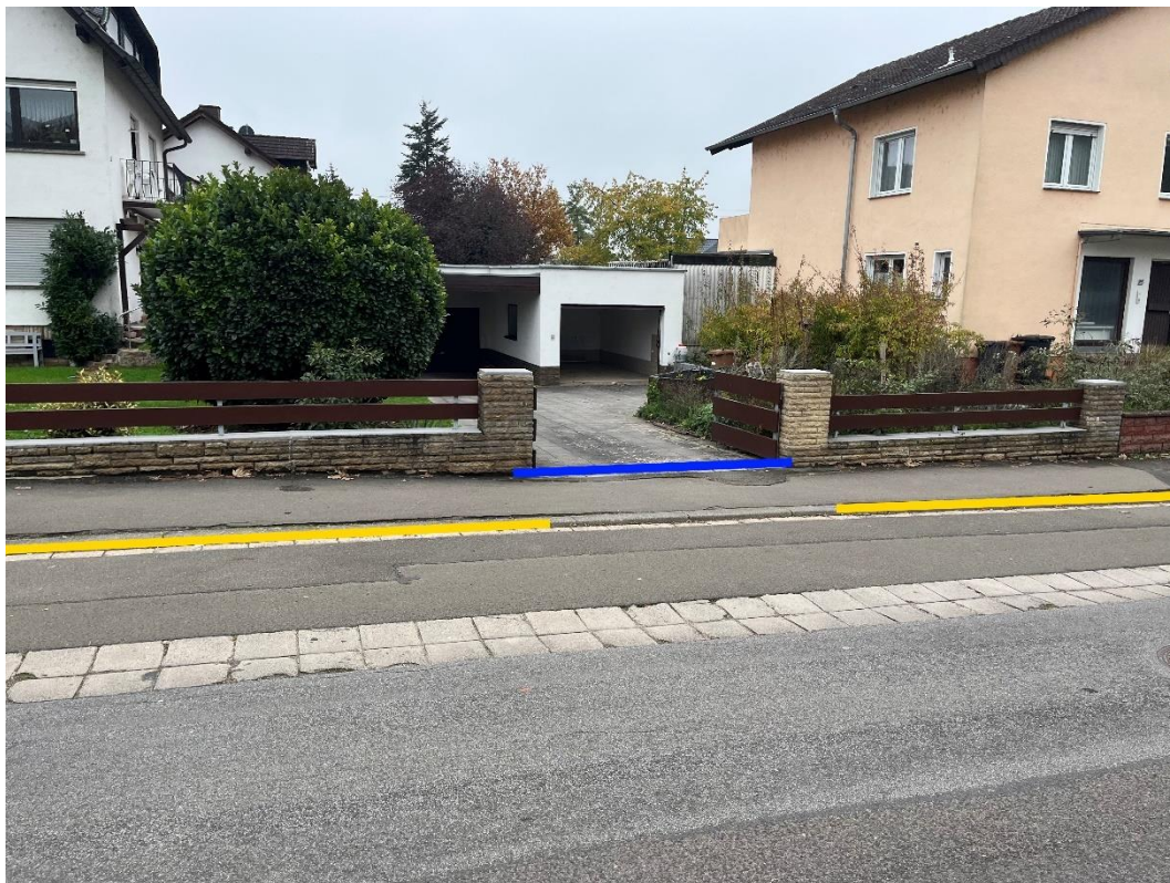
Abbildung 101: Notfließweg „Berlinstraße“ mit Objektschutzmaßnahmen (blau) und Bordanlagen (gelb)
