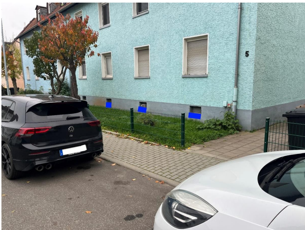
Abbildung 115: Notfließweg „Bülowstraße“ mit Objektschutzmaßnahmen (blau)
