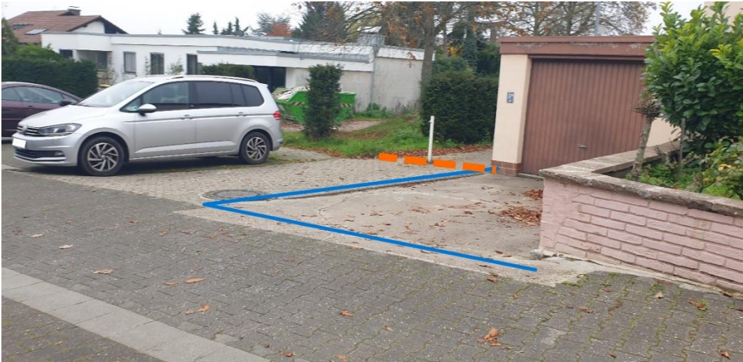
Abbildung 37: Notfließweg „Helmstraße“ mit Objektschutzmaßnahmen (blau) und Aufwallung (orange)
