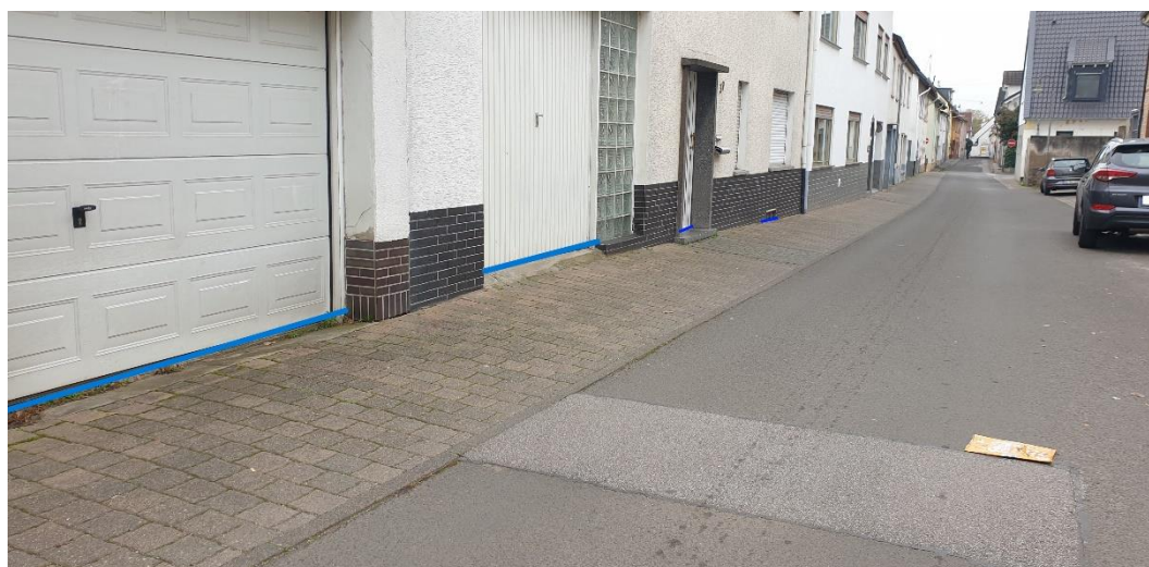
Abbildung 20: Notfließweg „Osterbergstraße“ mit Objektschutzmaßnahmen (blau) und Bordanlagen (gelb)
