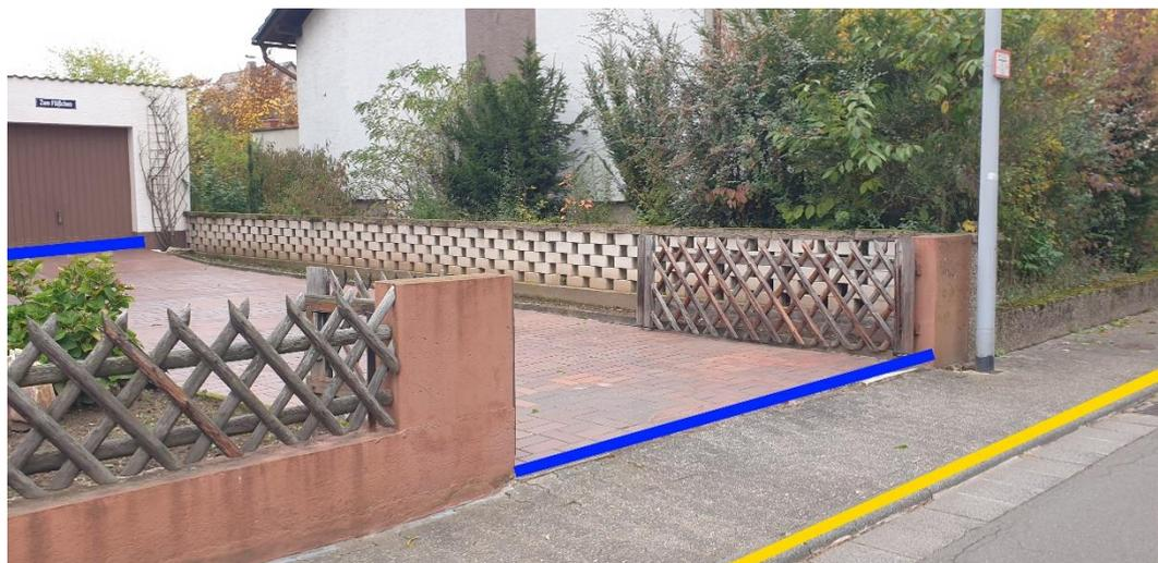
Abbildung 63: Notfließweg "Römerstraße" mit Objektschutzmaßnahme (blau) und Bordanlagen (gelb)
