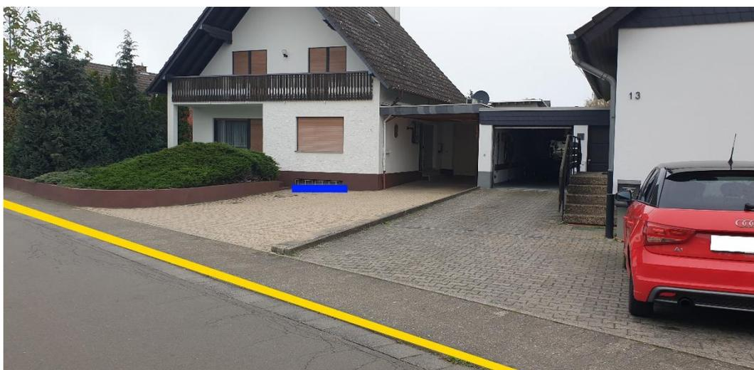
Abbildung 38: Notfließweg "Römerstraße" mit Objektschutzmaßnahme (blau) und Bordanlagen (gelb)
