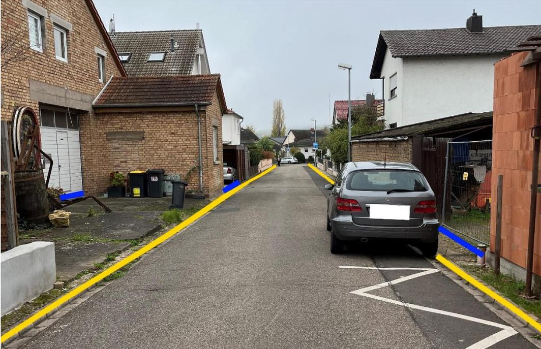
Abbildung 29: Notfließweg "Römerstraße" mit Objektschutzmaßnahme (blau) und Bordanlagen (gelb)
