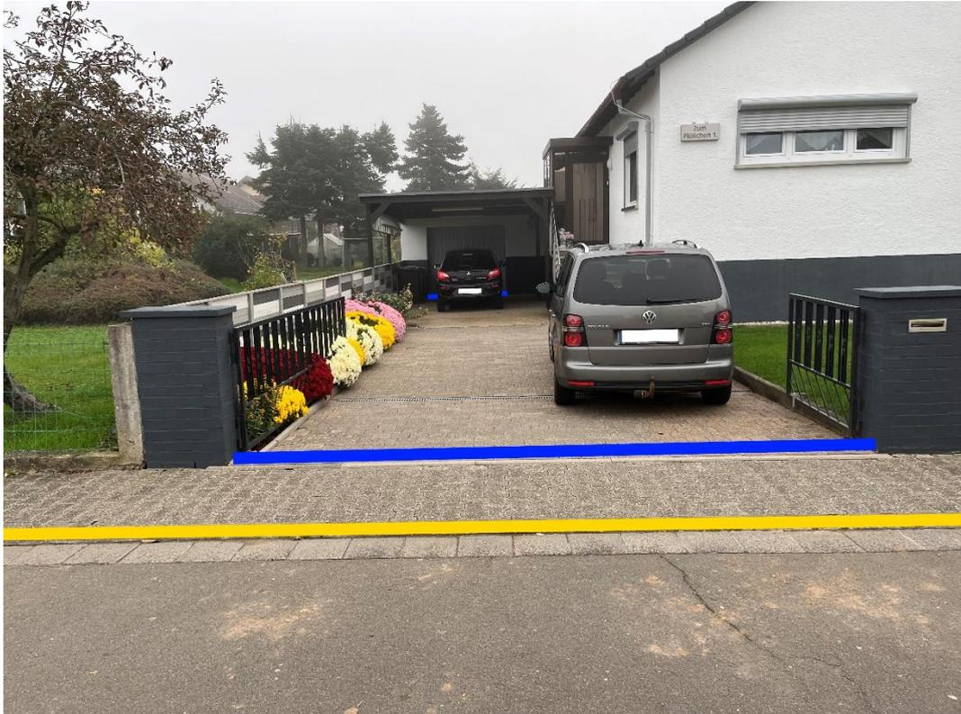
Abbildung 73: Notfließweg "Römerstraße" mit Objektschutzmaßnahme (blau) und Bordanlagen (gelb)
