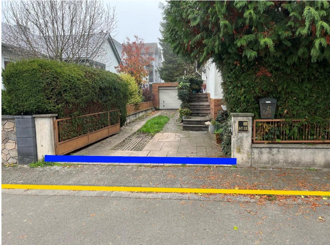
Abbildung 69: Notfließweg "Römerstraße" mit Objektschutzmaßnahme (blau) und Bordanlagen (gelb)
