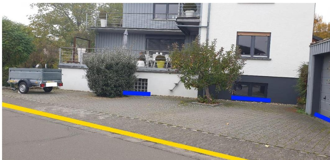
Abbildung 57: Notfließweg "Römerstraße" mit Objektschutzmaßnahme (blau) und Bordanlagen (gelb)
