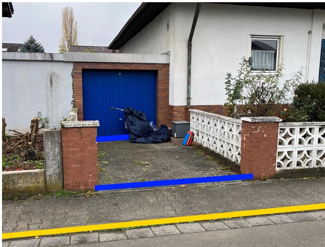
Abbildung 44: Notfließweg "Römerstraße" mit Objektschutzmaßnahme (blau) und Bordanlagen (gelb)
