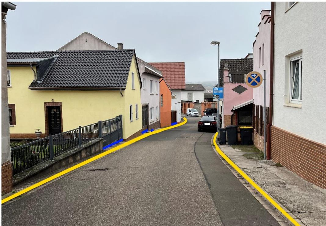
Abbildung 19: Notfließweg "Römerstraße" mit Objektschutzmaßnahme (blau) und Bordanlagen (gelb)
