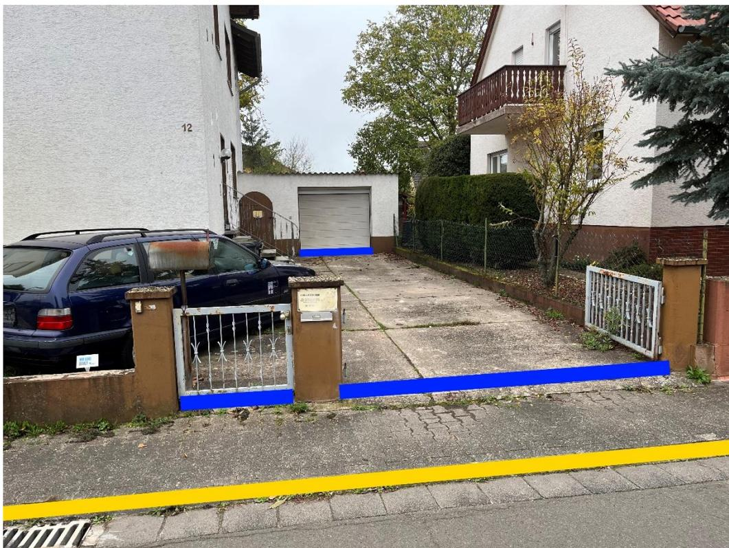
Abbildung 60: Notfließweg "Römerstraße" mit Objektschutzmaßnahme (blau) und Bordanlagen (gelb)
