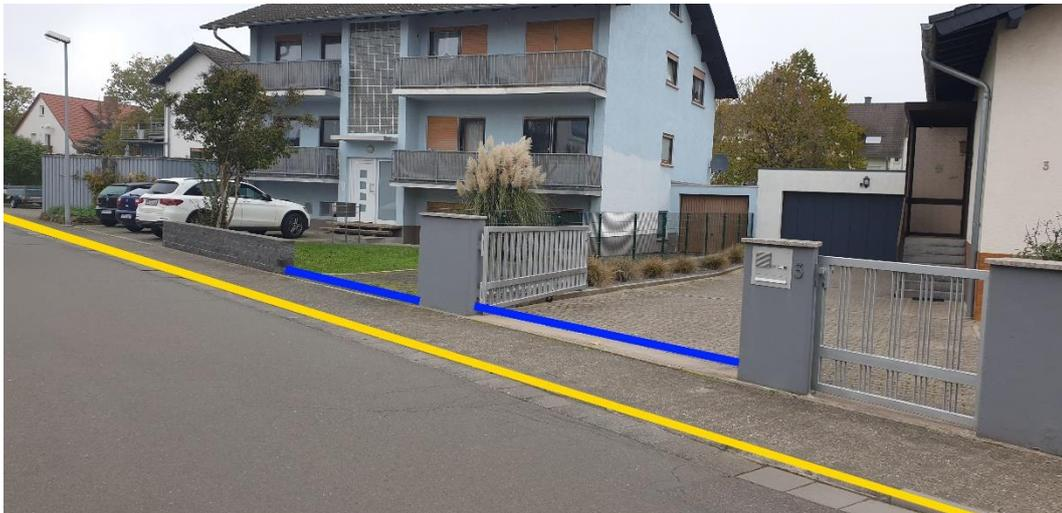
Abbildung 52: Notfließweg "Römerstraße" mit Objektschutzmaßnahme (blau) und Bordanlagen (gelb)
