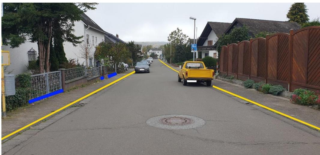
Abbildung 35: Notfließweg "Römerstraße" mit Objektschutzmaßnahme (blau) und Bordanlagen (gelb)
