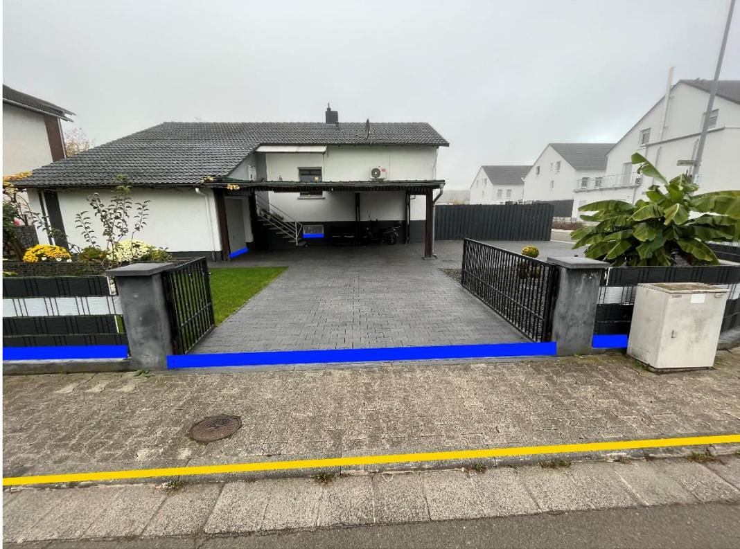
Abbildung 76: Notfließweg "Römerstraße" mit Objektschutzmaßnahme (blau) und Bordanlagen (gelb)
