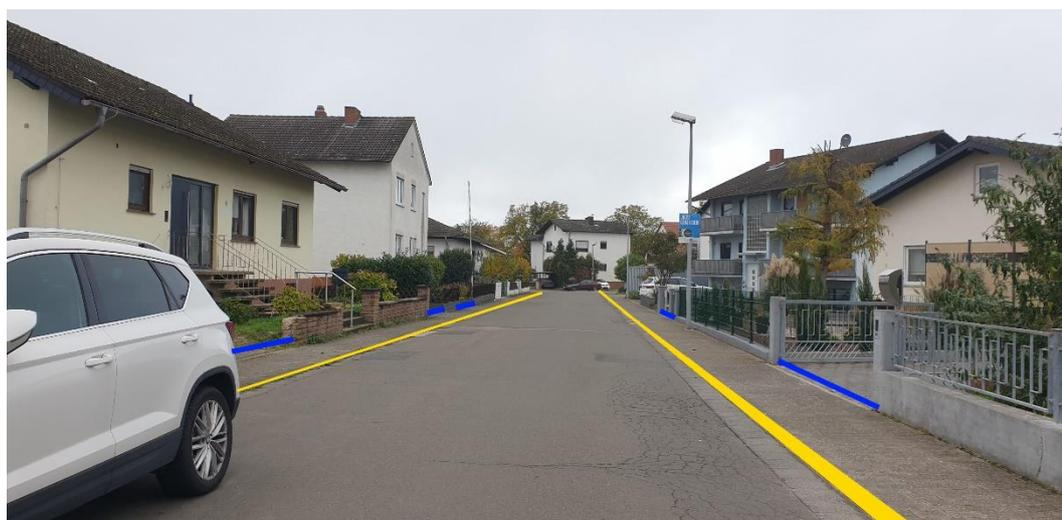
Abbildung 50: Notfließweg "Römerstraße" mit Objektschutzmaßnahme (blau) und Bordanlagen (gelb)
