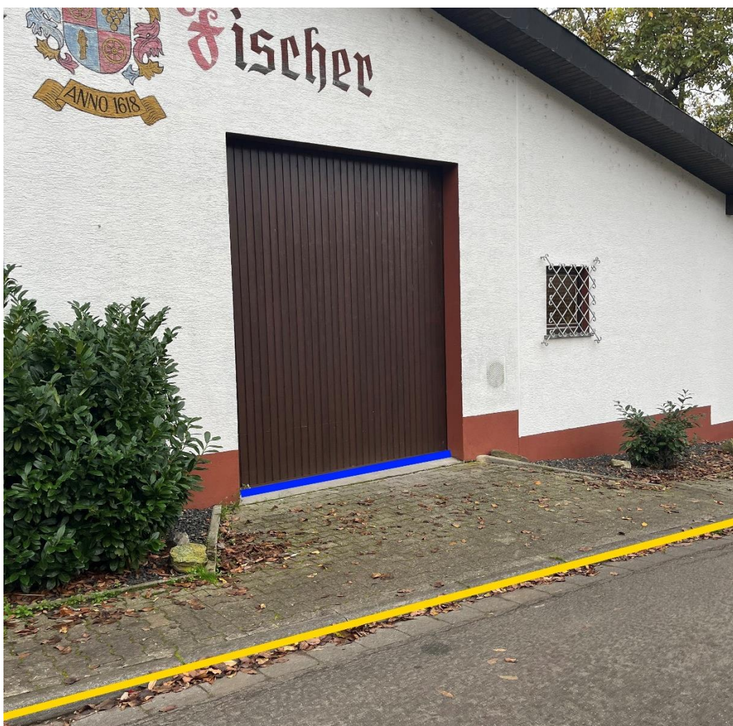
Abbildung 46: Nottließweg "Marienstraße" mit Objektschutzmaßnahmen (blau) und Bordanlage (gelb)
