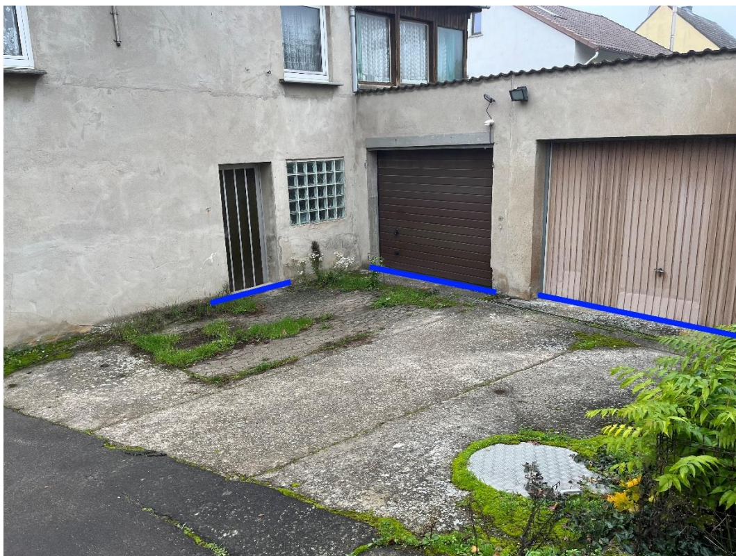
Abbildung 7: Notfließweg "Dalbusgasse" mit Objektschutzmaßnahmen (blau)
