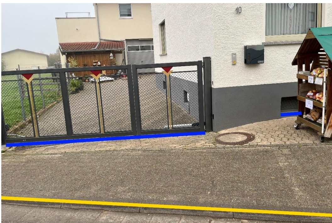
Abbildung 102: Nottfließweg „Klosterweg“ mit Objektschutzmaßnahmen (blau) und Bordanlagen (gelb)
