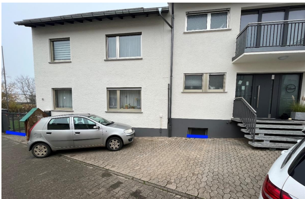
Abbildung 100: Notfließweg „Klosterweg“ mit Objektschutzmaßnahmen (blau)
