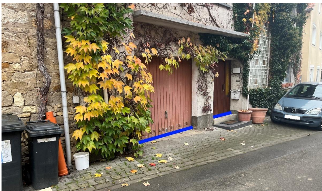
Abbildung 28: Notfließweg "Dietengasse" mit Objektschutzmaßnahmen (blau)
