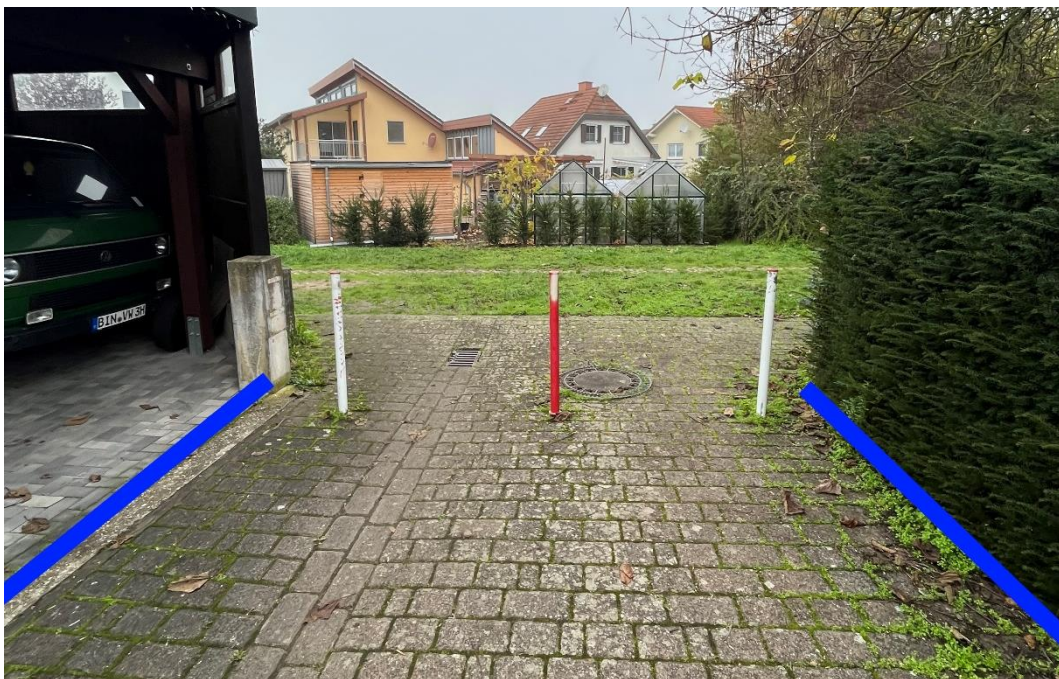
Abbildung 55: Notfließweg „Kurmainzstraße" mit Objektschutzmaßnahmen (blau)
