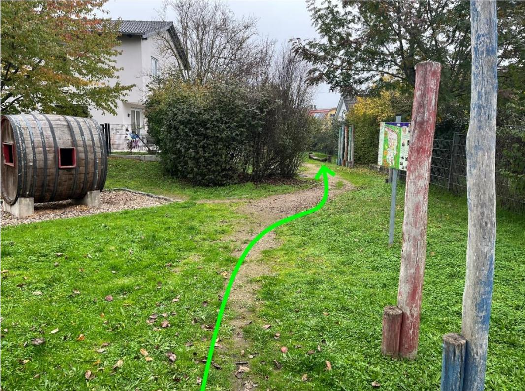
Abbildung 40: Notfließweg "Clara-Schuhmann-Straße" mit möglicher Entwässerung in multifunktionaler Fläche (grün)
