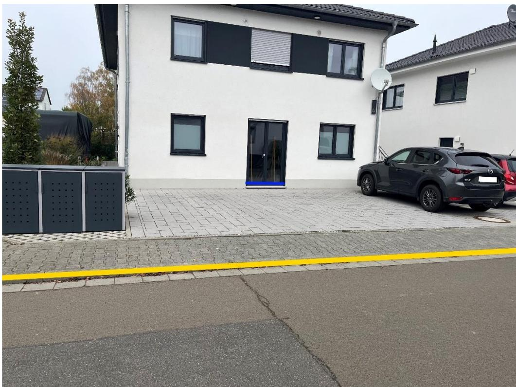
Abbildung 65: Notfließweg "Balthasarstraße" mit Objektschutzmaßnahmen (blau) und Bordanlagen (gelb)
