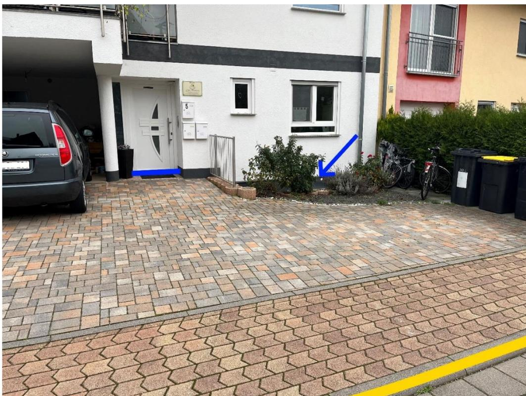
Abbildung 35: Notfließweg "Clara-Schuhmann-Straße" mit Objektschutzmaßnahmen (blau) und Bordanlage (gelb)
