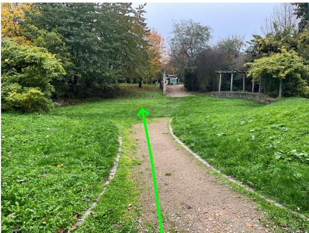
Abbildung 43: Notfließweg "Clara-Schuhmann-Straße" mit möglicher Entwässerung in multifunktionaler Fläche (grün)
