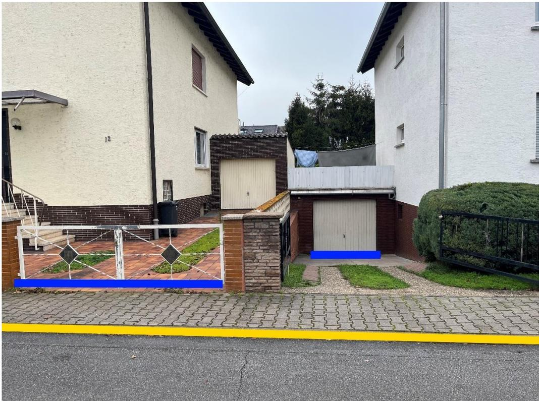
Abbildung 75: Notfließweg „Kasparstraße“ mit Objektschutzmaßnahmen (blau) und Bordanlagen (gelb)
