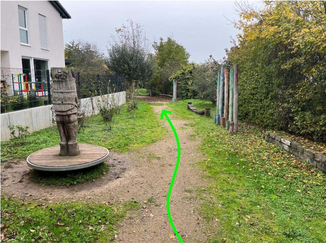
Abbildung 41: Notfließweg "Clara-Schuhmann-Straße" mit möglicher Entwässerung in multifunktionaler Fläche (grün)
