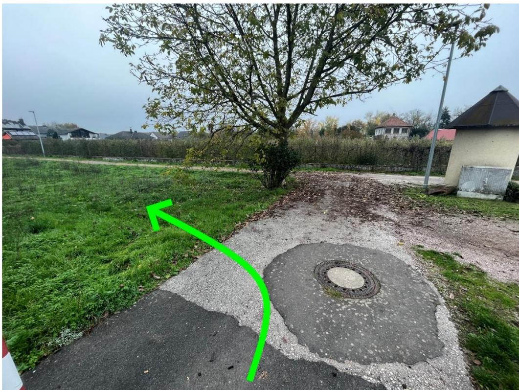
Abbildung 51: Notfließweg "Ida-Dehmel-Coblenz-Straße" mit Entwässerung in die Fläche (grün)
