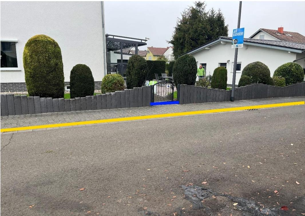
Abbildung 71: Notfließweg "Balthasarstraße" mit Objektschutzmaßnahmen (blau) und Bordanlagen (gelb)
