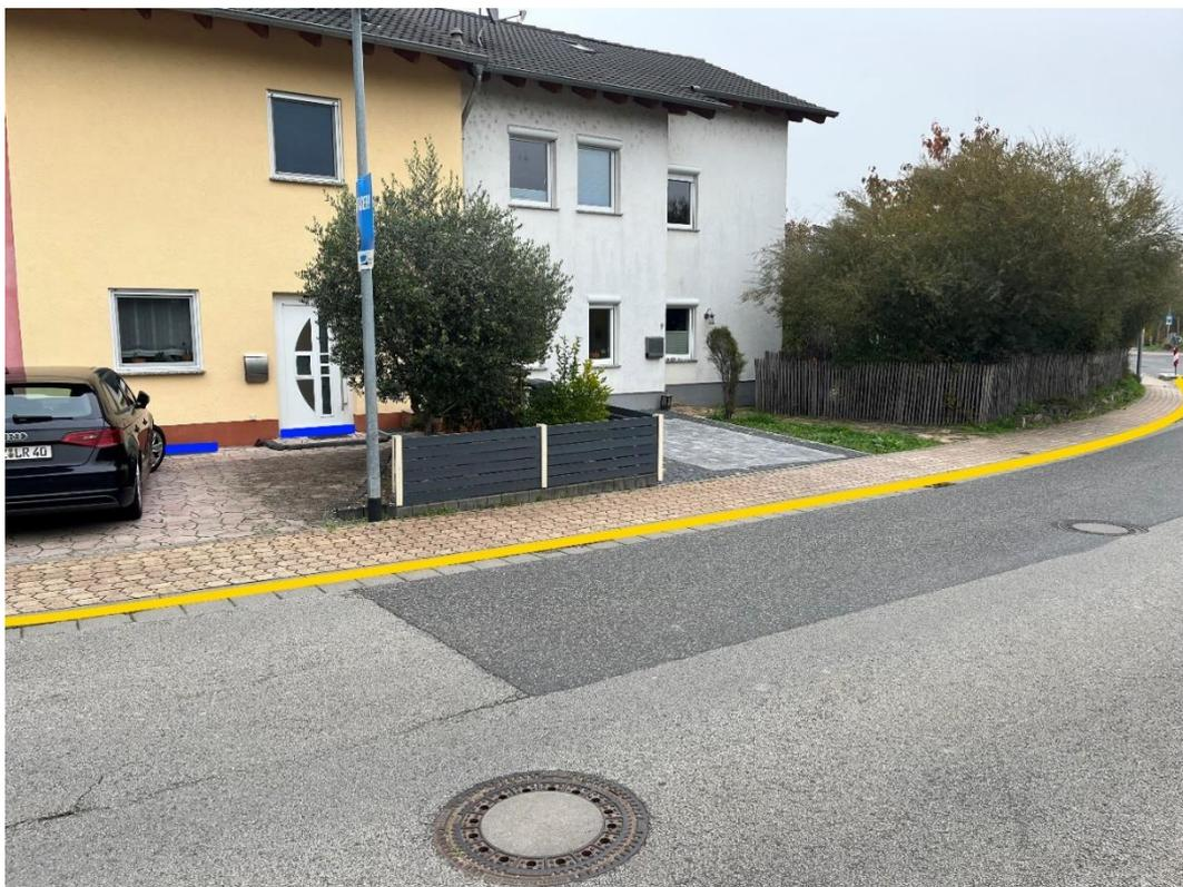
Abbildung 36: Notfließweg "Clara-Schuhmann-Straße" mit Objektschutzmaßnahmen (blau) und Bordanlage (gelb)
