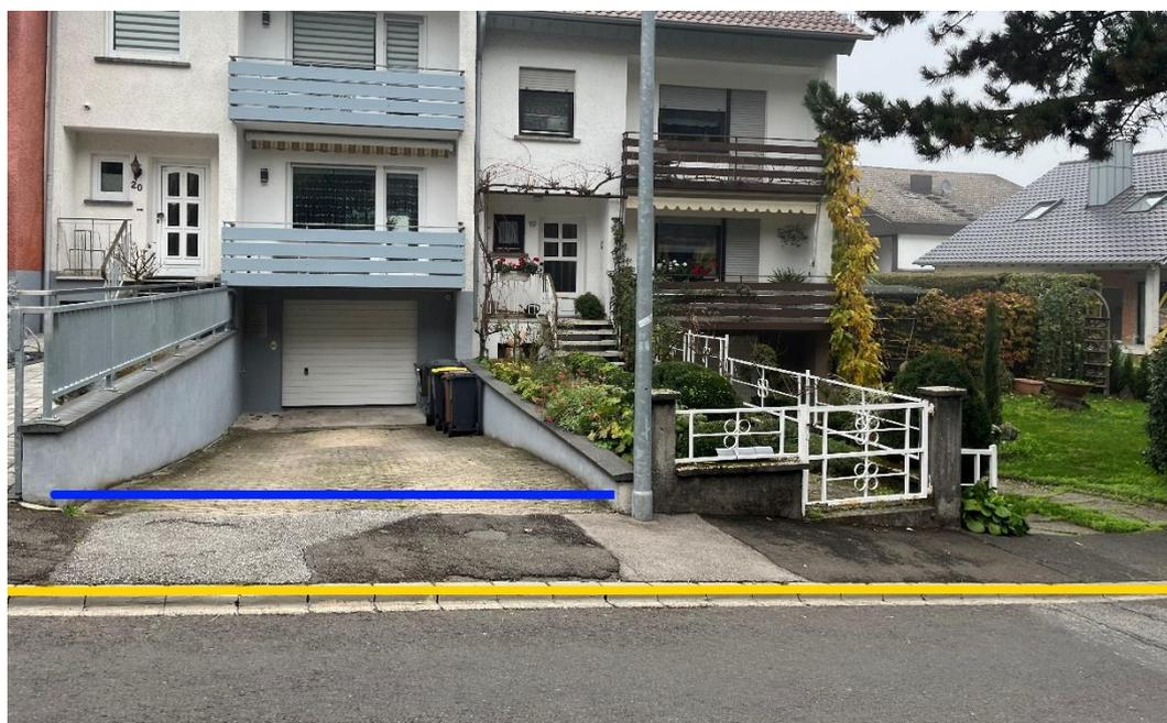
Abbildung 28 - Notfließweg „Im Bangert“ mit Objektschutzmaßnahmen (blau) und Bordanlagen (gelb)
