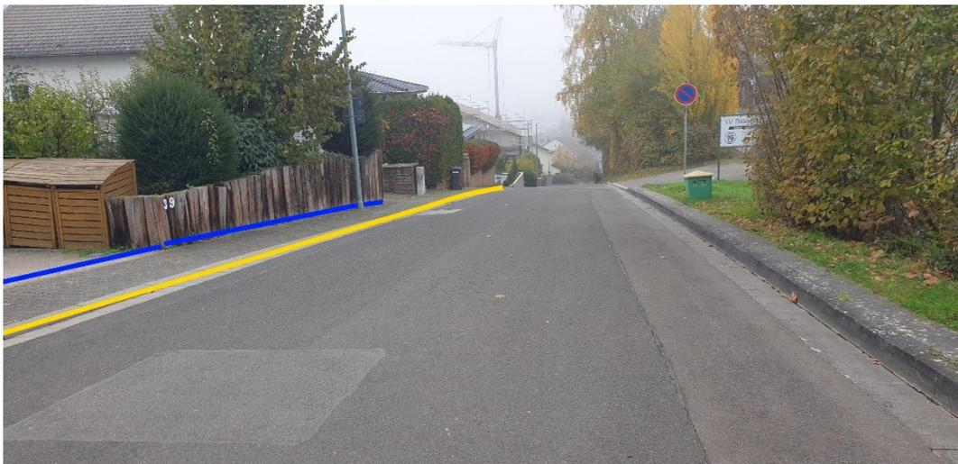
Abbildung 15 - Notfließweg „Im Bangert“ mit Objektschutzmaßnahmen (blau) und Bordanlagen (gelb)
