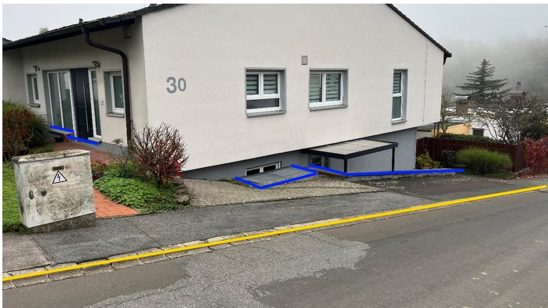
Abbildung 10 Notfließweg "Im Bangert" mit Objektschutzmaßnahmen (blau) und
