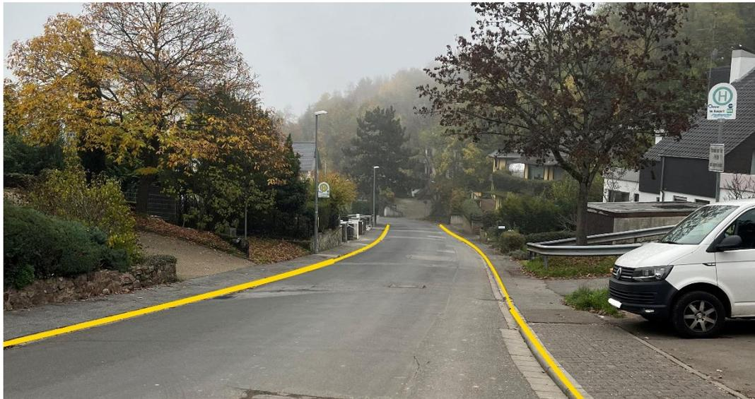
Abbildung 21 - Notfließweg „Im Bangert“ mit Objektschutzmaßnahmen (blau) und Bordanlagen (gelb)
