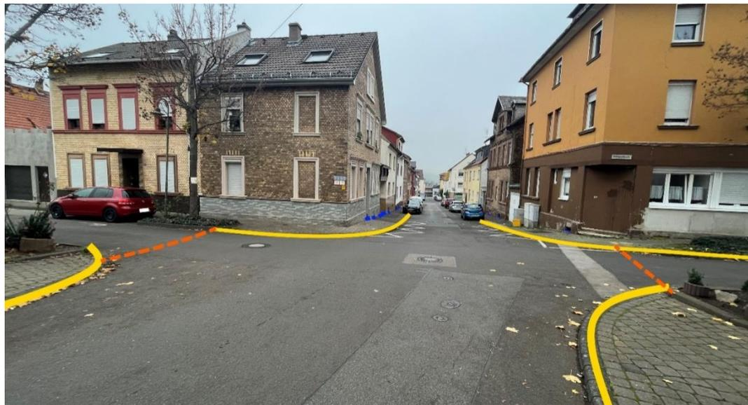
Abbildung 76 - Notfließweg „Schlossstraße“ mit Objektschutzmaßnahmen (blau), Aufwallung (orange) und Bordanlagen (gelb)
