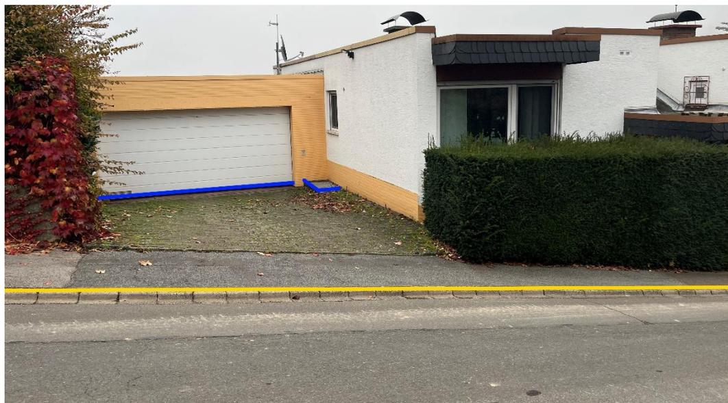
Abbildung 11 - Notfließweg „Im Bangert“ mit Objektschutzmaßnahmen (blau) und Bordanlagen (gelb)
