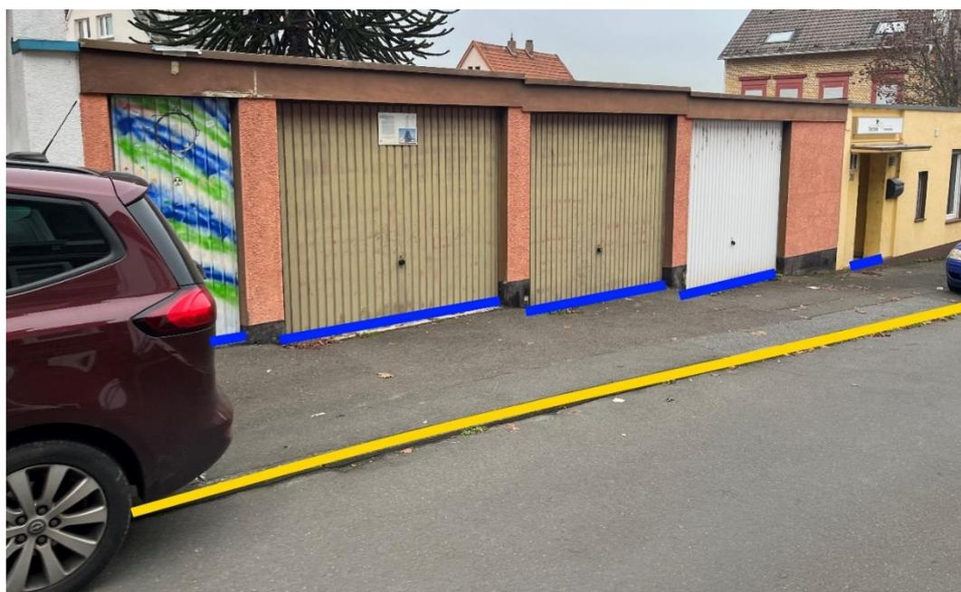
Abbildung 75 - Notfließweg „Schlossstraße“ mit Objektschutzmaßnahmen (blau) und Bordanlagen (gelb)
