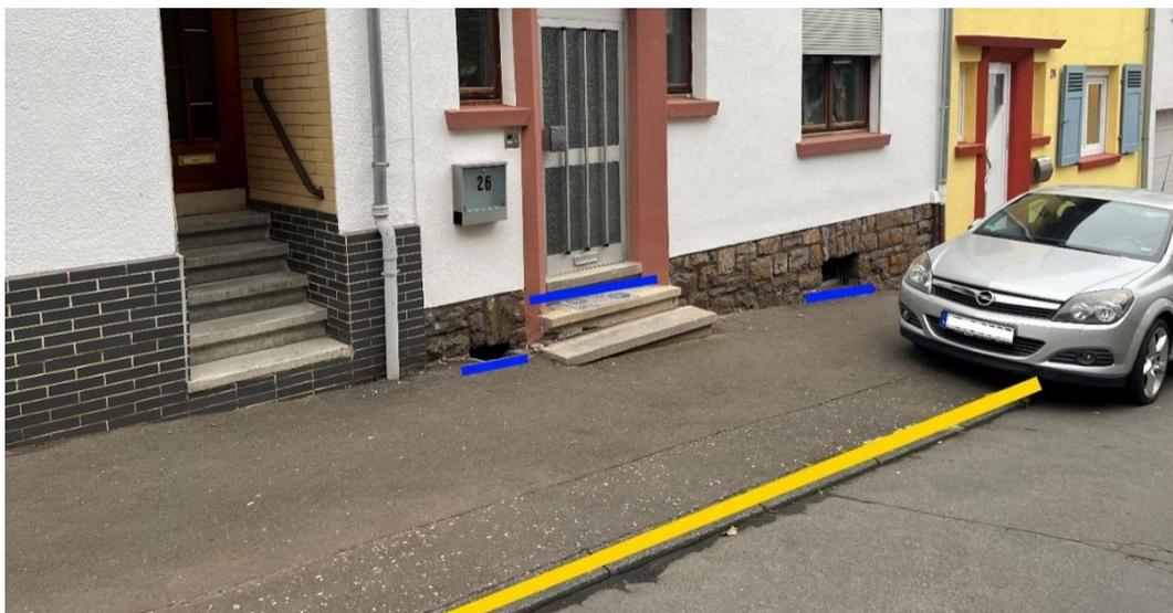
Abbildung 71 - Notfließweg „Schlossstraße“ mit Objektschutzmaßnahmen (blau) und Bordanlagen (gelb)
