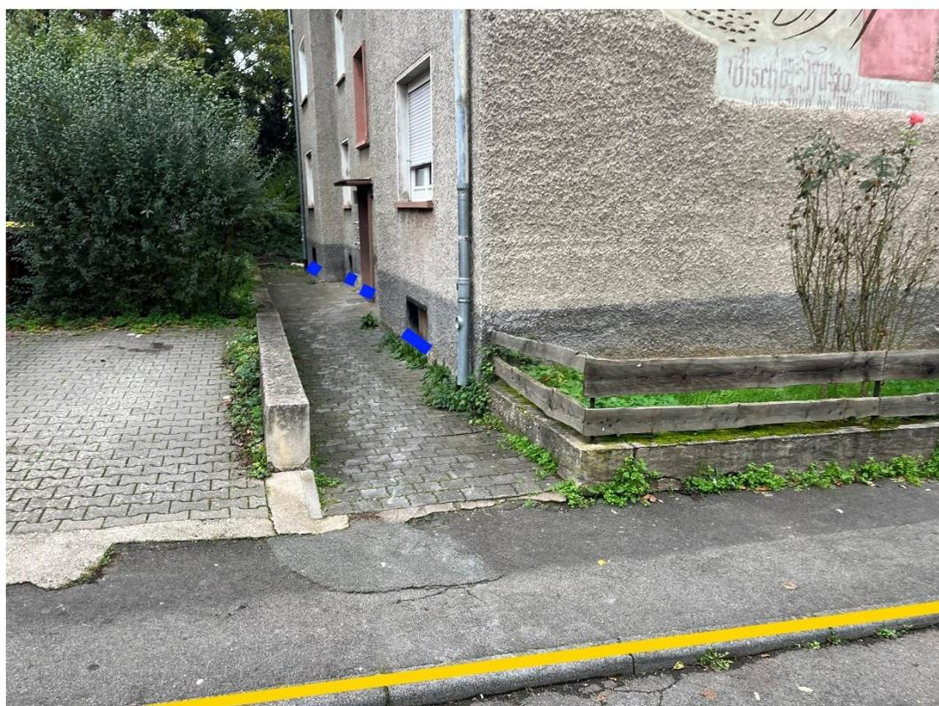
Abbildung 119 - Notfließweg „Prinzenkopfstraße“ mit Objektschutzmaßnahmen (blau) und Bordanlagen (gelb)
