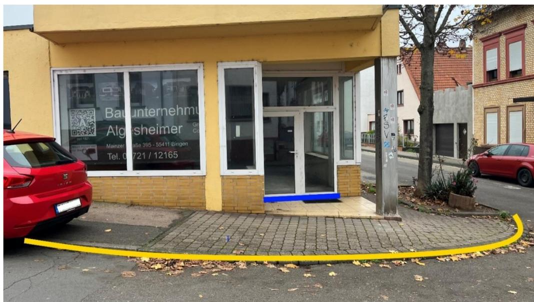
Abbildung 77 - Notfließweg „Schlossstraße“ mit Objektschutzmaßnahmen (blau) und Bordanlagen (gelb)
