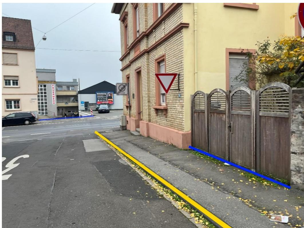
Abbildung 93 - Notfließweg „Schlossstraße“ mit Objektschutzmaßnahmen (blau) und Bordanlagen (gelb)
