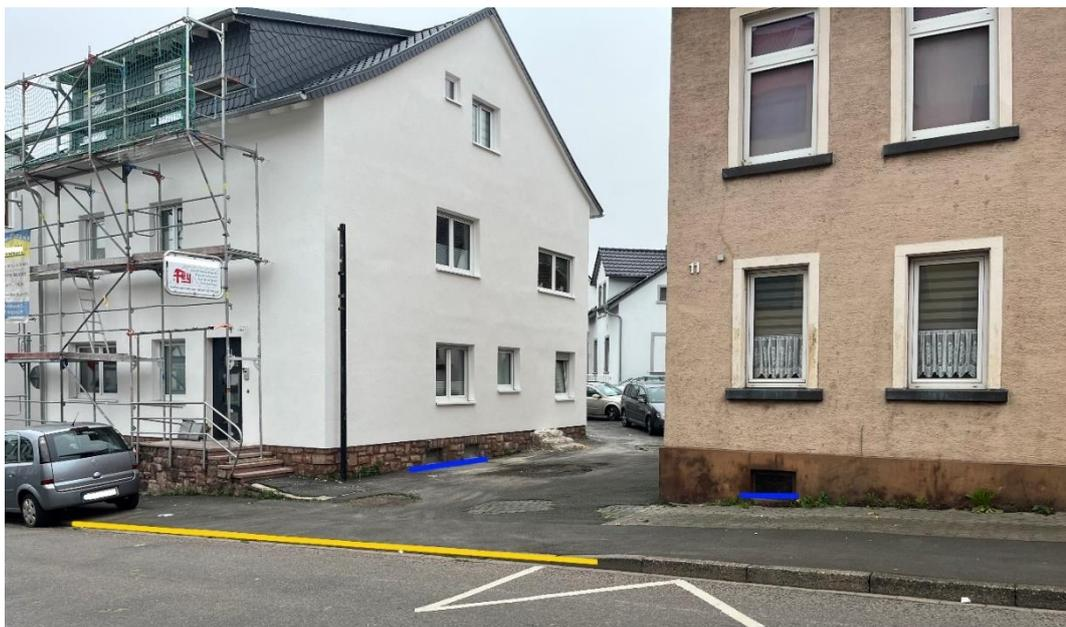
Abbildung 57 - Notfließweg „Stromberger Straße“ mit Objektschutzmaßnahmen (blau) und Bordanlagen (gelb)
