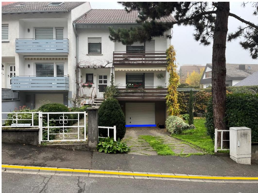
Abbildung 29 - Notfließweg „Im Bangert“ mit Objektschutzmaßnahmen (blau) und Bordanlagen (gelb)
