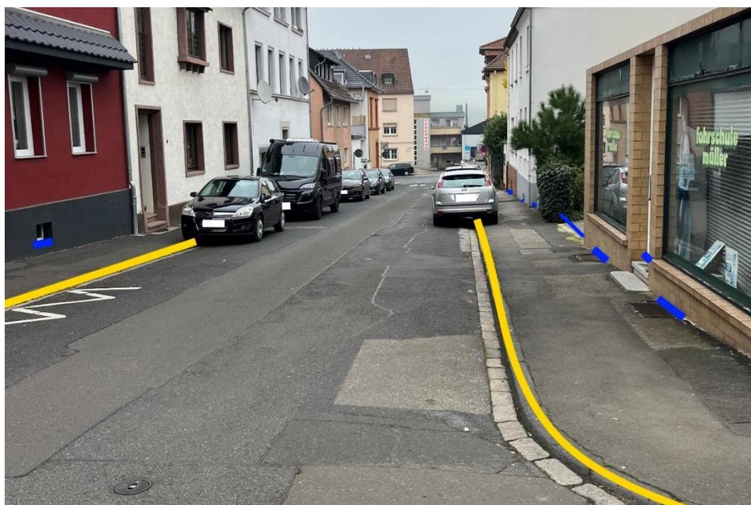
Abbildung 85 - Notfließweg „Schlossstraße“ mit Objektschutzmaßnahmen (blau) und Bordanlagen (gelb)
