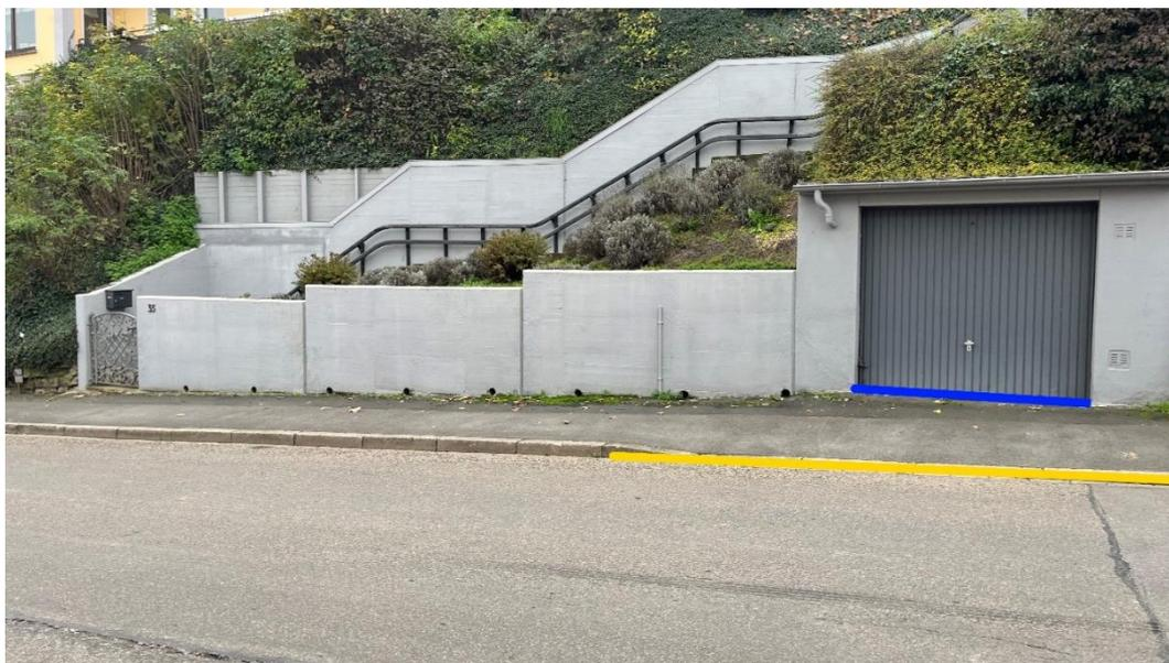
Abbildung 49 - Notfließweg „Stromberger Straße“ mit Objektschutzmaßnahmen (blau) und Bordanlagen (gelb)
