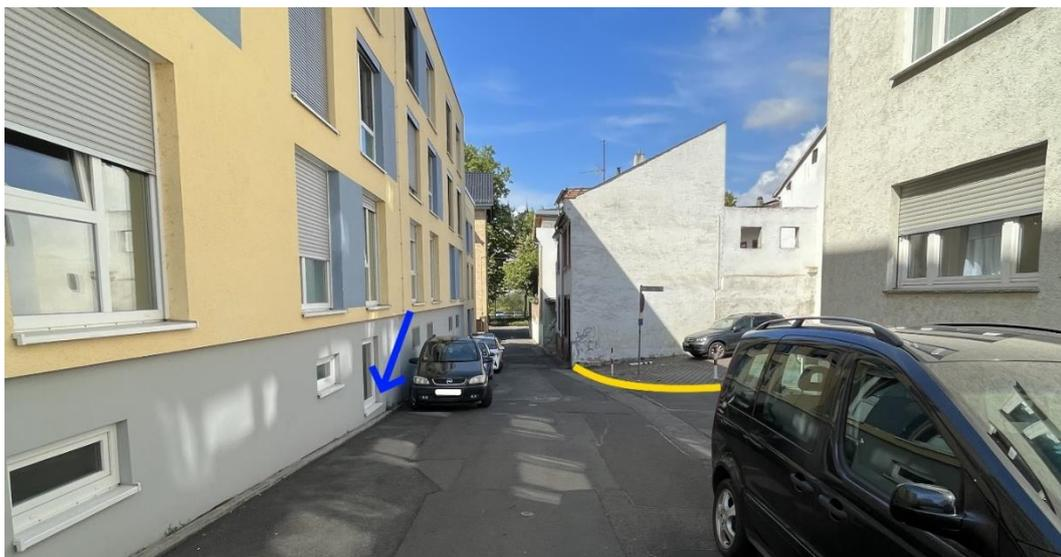
Abbildung 36 Notfließweg Beuchergasse mit Objektschutzmaßnahmen (blau) und Bordanlagen (gelb)
