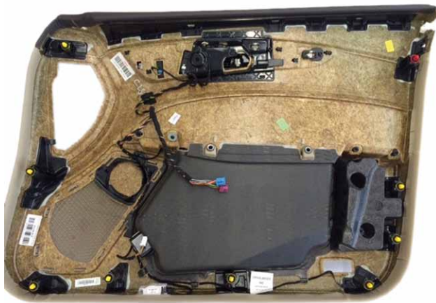
Abb. 1: Auf einem Naturfaser Composite basierende Türverkleidung der CLS-Klasse von Mercedes Benz
