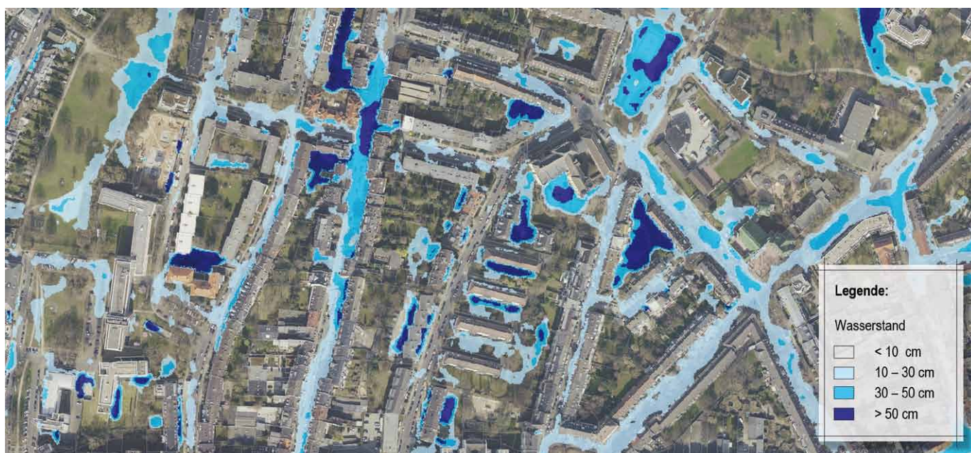
Abb. 2: Ergebnisdarstellung einer Überflutungsberechnung mittels hydrodynamischer 2D-Simulation auf Basis eines 1x1m-Geländemodells (Kartenausschnitt)
