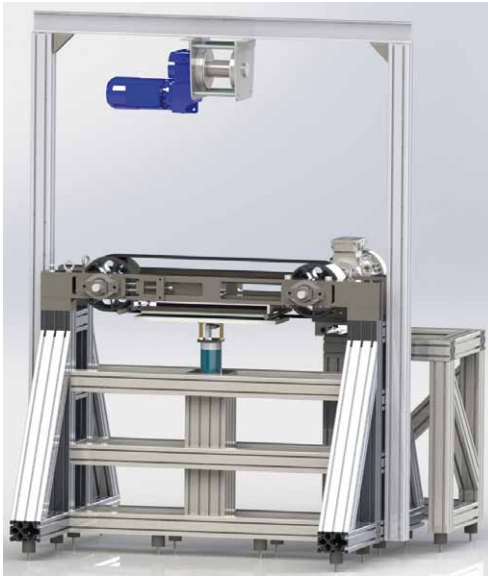
Abb. 1: Konstruktion des Tribometers
