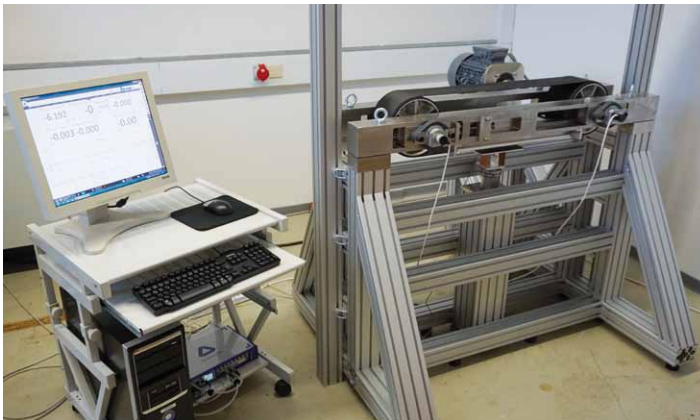
Abb. 2: Eistribometer zur Messung der Reibung PE-Eis
