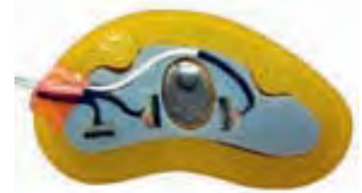
Zusammengebaute Ferseneinheit mit Sensoren für den Einbau im Schuh (Blick von unten)
