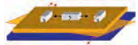
Abbildung 3: Die Fersenkonstruktion besteht im Prinzip aus zwei aufeinander gleitenden dreidimensional geformten Platten. Die Verschiebung lässt sich mit drei linear messenden Positionssensoren eindeutig bestimmen, wie es rechts im Bild skizziert wird (Quelle: FH Kaiserslautern).
