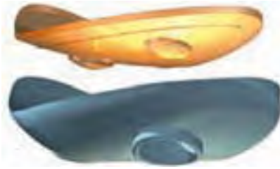
Abbildung 3: Die Fersenkonstruktion besteht im Prinzip aus zwei aufeinander gleitenden dreidimensional geformten Platten. Die Verschiebung lässt sich mit drei linear messenden Positionssensoren eindeutig bestimmen, wie es rechts im Bild skizziert wird (Quelle: FH Kaiserslautern).
