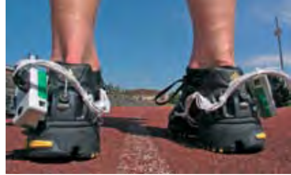
Abbildung 1: Messsystem mit Datenlogger zur Funktionsanalyse eines Laufschuhs (Quelle: FH-Kaiserslautern, R. Lilischkis)
