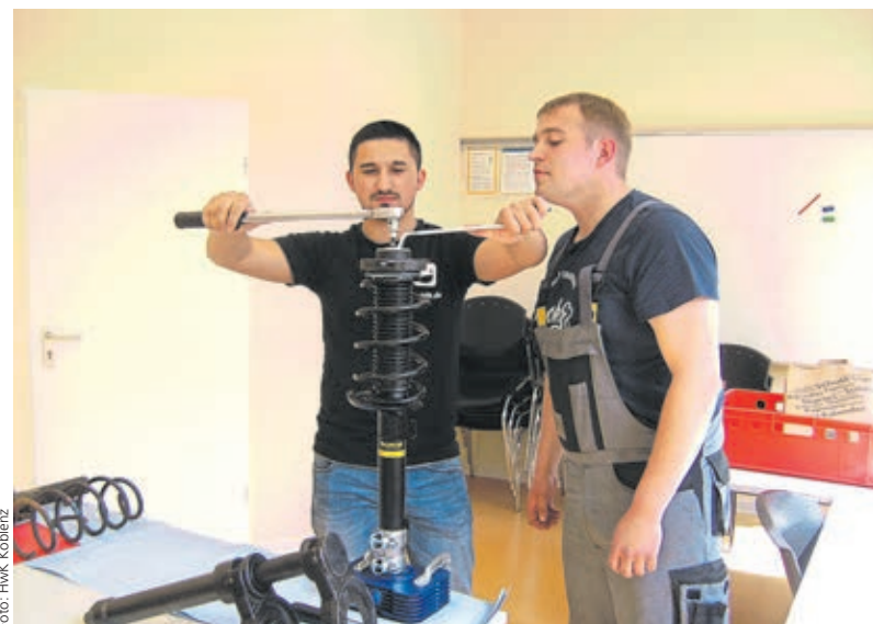
KFZ-Mechatroniker Tobias Preuß (rechts) unterweist einen fiktiven Auszubildenden bei der Reparatur eines Federbeins
