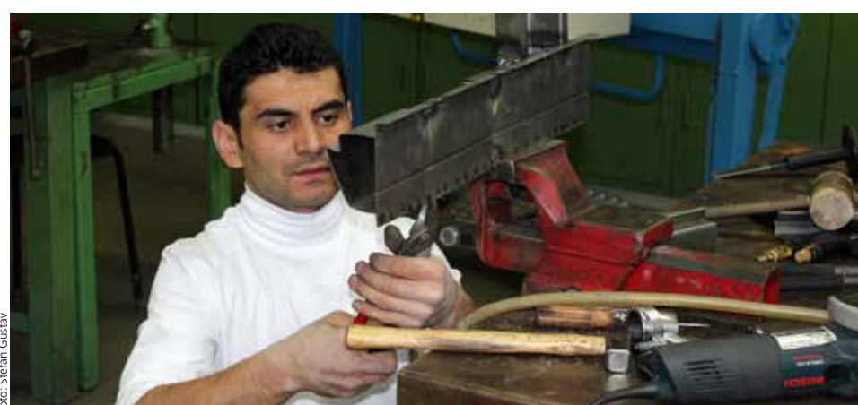
Hasan Albayrak fertigt einen Türschweller nach einer vorgegebenen Zeichnung an
