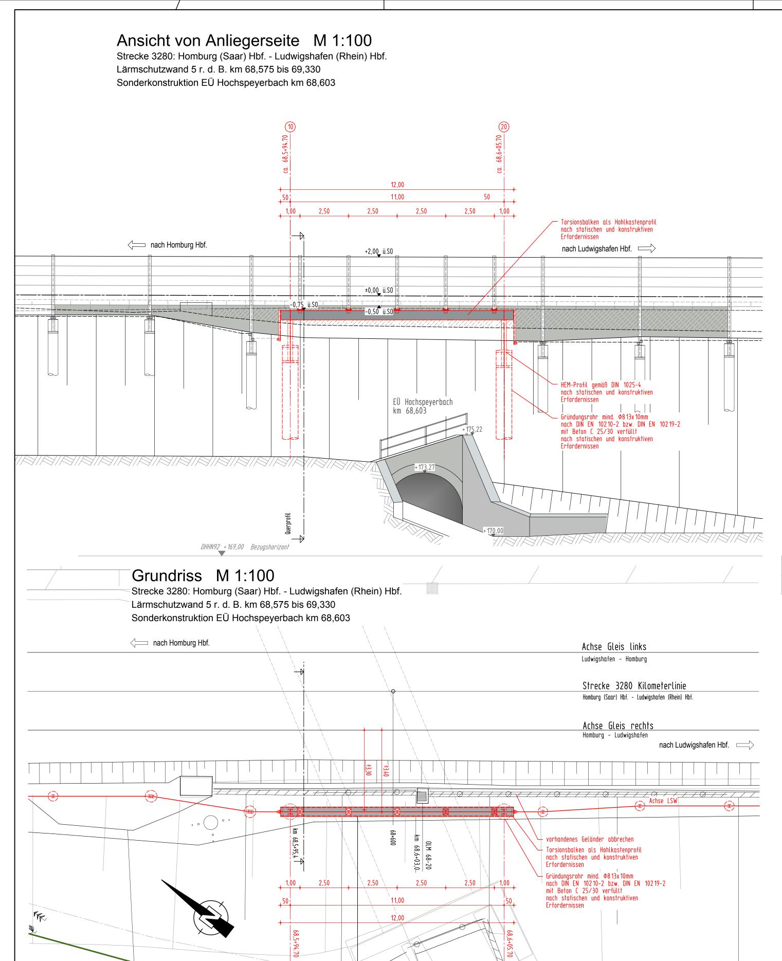
Sonderkonstruktion LSW 5 r.d.B. km 68,603 EÜ Hochspeyerbach Länge: ca. 12,00 m Höhe LSW: ≧2,00 m ü.SO
