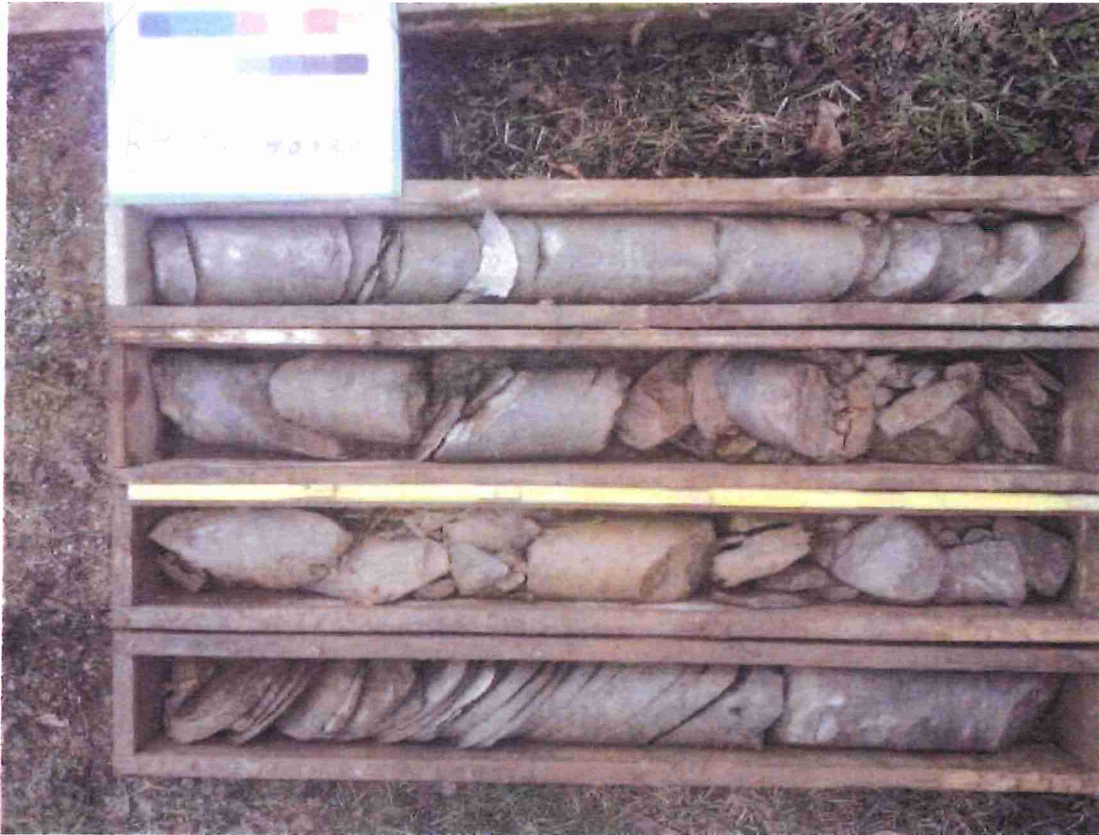
Bild 7: Bohrung 4, Bohrmeter 4,00 m bis 8,00 m
