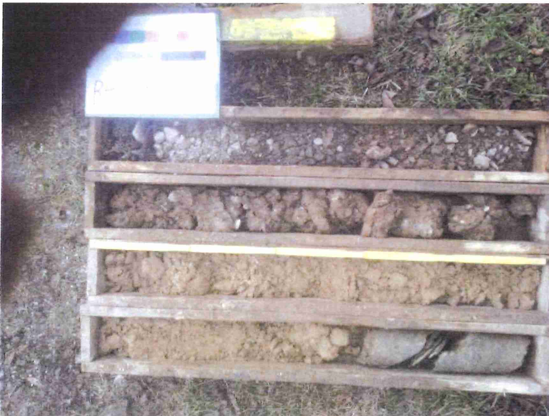
Bild 6: Bohrung 4, Bohrmeter 0,00 m bis 4,00 m
