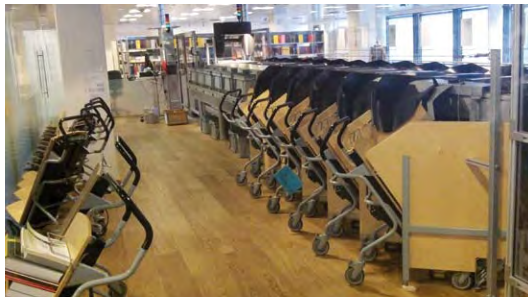
Die RFID-unterstützte Rückgabe-Roboter-Anlage in der Bibliothek von Kolding wird von einem privaten Unternehmen betrieben und erhöht die Effizienz einer raschen Verteilung zurückgegebener Medien auf räumlich zugeteilte Buchwagen bis hin zur leichteren Rückordnung in die Regale und Präsentationsmöbel.
