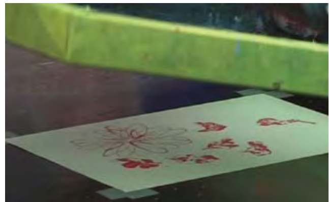
Entstehen einer „Pfingstrose“ im Siebdruckverfahren.
