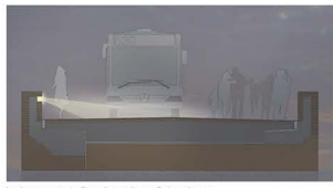
In den neuem Aufbau integrierte Beleuchtung
