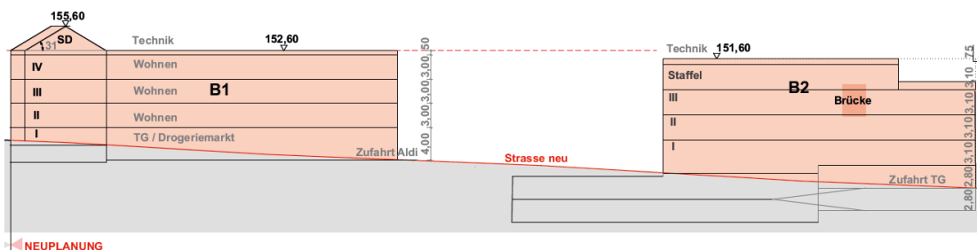
Abbildung 11: Längsprofil der geplanten Stichstraße
