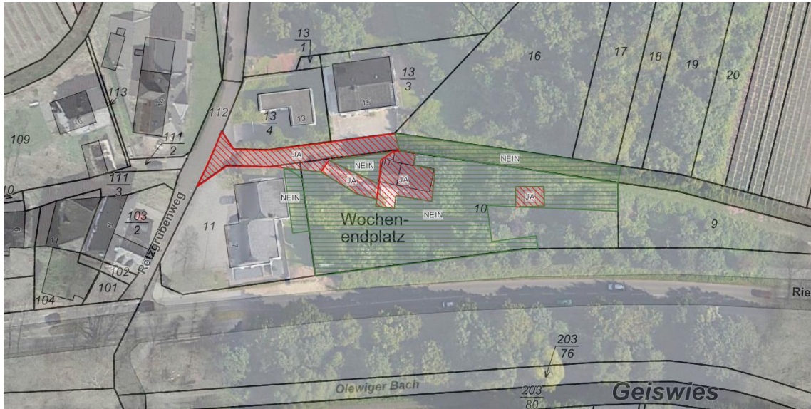
Abbildung 6: Versiegelung des Bestandes (rot = Bestandsversiegelung, grün = Grünflächen).
