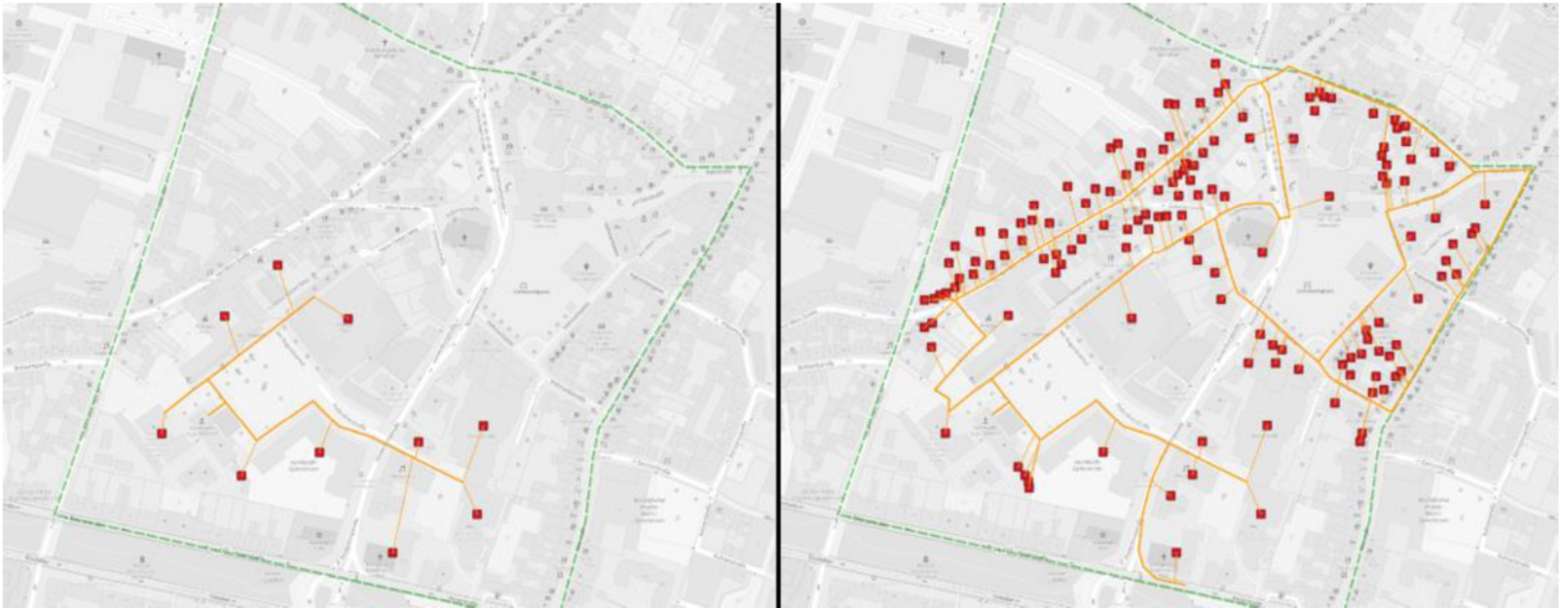
links: kleines Nahwärmenetz mit 25% Anschlussquote;
