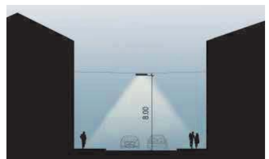
Regelschnitt Hauptstraße mit Überspannungsleuchte
