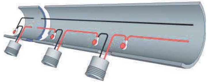
Prinzip Handlaufleuchten punktuell (Hersteller z.B. WILA)
