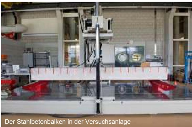
Der Stahlbetonbalken in der Versuchsanlage
