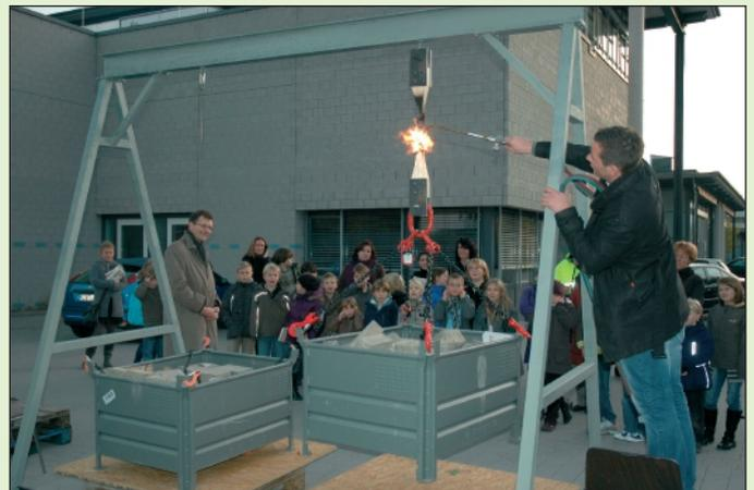
Der Metallstab hat schon versagt. Das Holz hält und hält und hält ... Prof. Dr.-Ing. Detlev Ibach (links) und sein Team von der FH Koblenz hatten eine aufwändige Konstruktion vorbereitet
