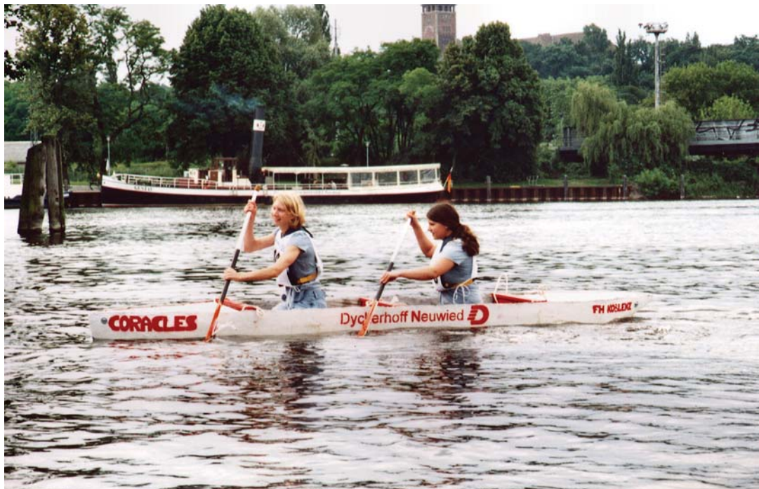
Bild 5: Betonkanu als dünnwandiges dichtes Präzisionsbauteil (9. Deutsche Betonkanu-Regatta 2002 in Potsdam)
