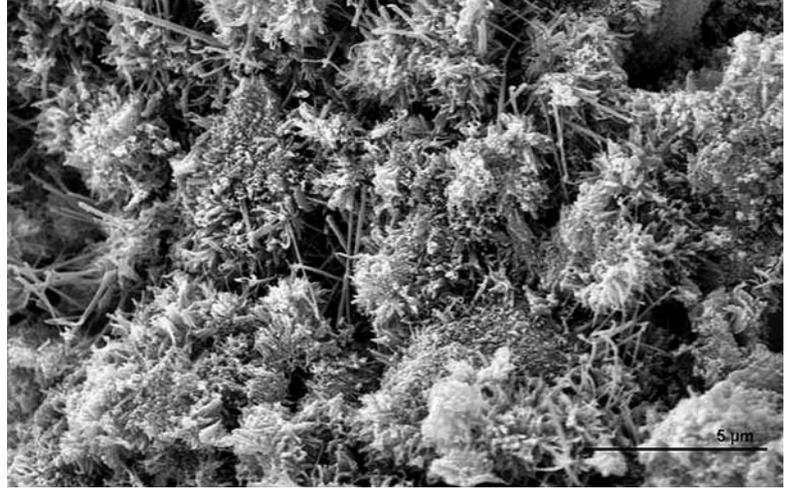
**Bild 1:** Porenreicher Zementstein von "Normalzement" ohne Feinabstimmung (Wilhelm Dyckerhoff Institut, Wiesbaden)
