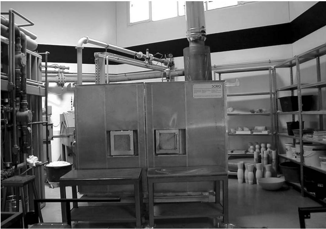
den die Scherben zum Aufschmelzen durch eine Öffnung im Feuerungsraum eingelegt. Durch eine zweite Öffnung im Arbeitsteil wird das aufgeschmolzene, blasenfreie Glas entnommen und kann verarbeitet werden.
