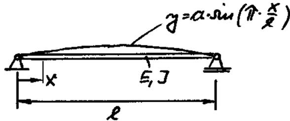
Weisen Sie mit dem Rayleigh-Verfahren nach, dass diese Eigenfrequenz nach folgender Gleichung berechnet werden kann:
