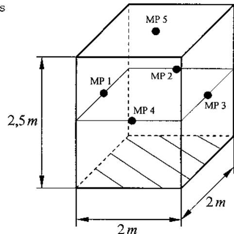
Bestimmen Sie den Schalleistungspegel  $L_w$  der Maschine! Dabei kann mit den vereinfachten Formeln gerechnet werden (Die Messflächen seien näherungsweise gleich groß).
