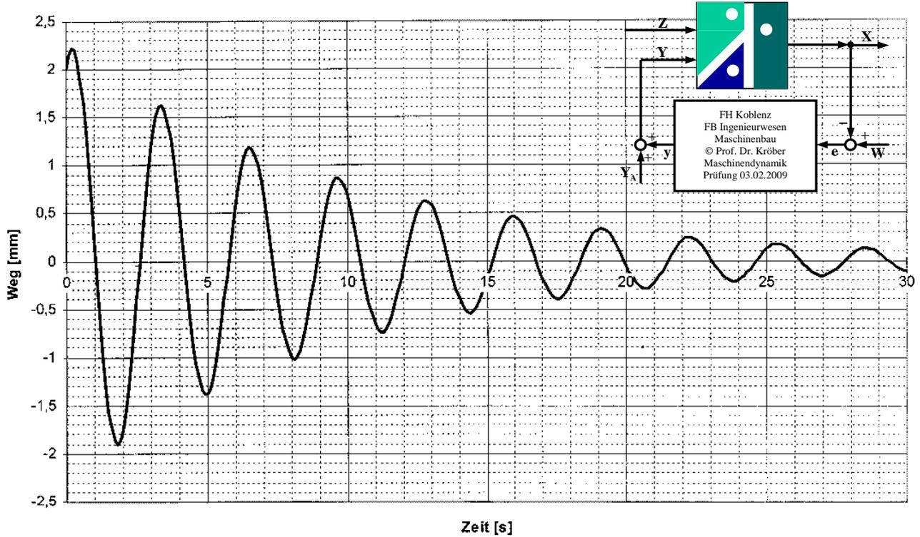
Bestimmen Sie das logarithmische Dekrement  $\Lambda$ , den Dämpfungsgrad  $\vartheta$ , die Periodendauer  $T_d$  sowie die Abklingkonstante  $\delta$  (es kann angenommen werden:  $T_0 \approx T_d$  bzw.  $\omega_0 \approx \omega_d$ )!
