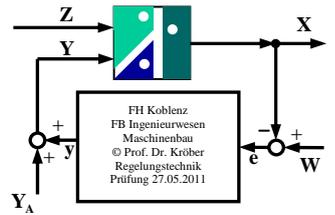
215)  $(J_s + m l_s^2) \ddot{\varphi} = -k_p \cdot \varphi - k_D \cdot \dot{\varphi} + m \cdot g \cdot l_s \cdot \varphi$
