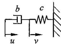
Hilfestellung: Die Kraft im Dämpfer ist stets gleich der Kraft in der Feder.
