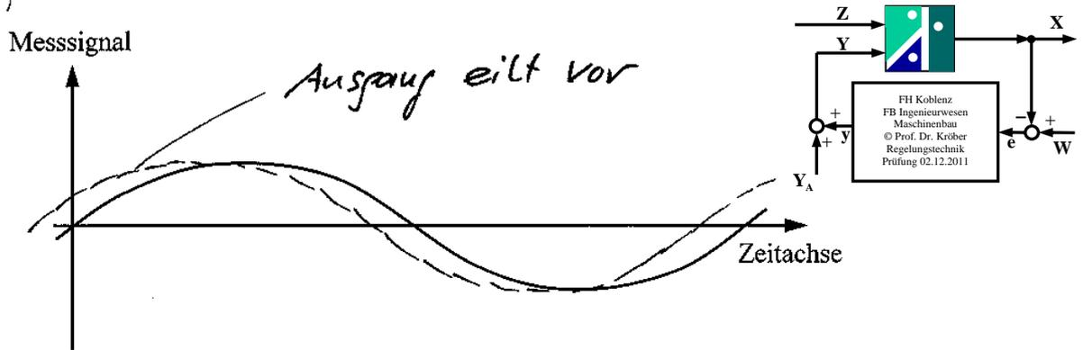
9. Von dem abgebildeten Regelkreis fehlen an den Summationspunkten die Vorzeichen. Ferner fehlen in zwei Übertragungsblöcken die Einträge der Verläufe für die Sprungantwort. Bitte ergänzen Sie die fehlenden Eintragungen!
