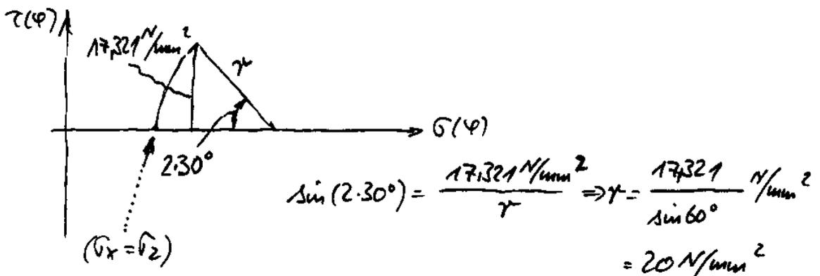
Weil  $\sigma_x = 40 \text{ N/mm}^2$  die kleinere Hauptspannung sein muss (Rohr, bzw. dünnwandiges Rohr) folgt:
