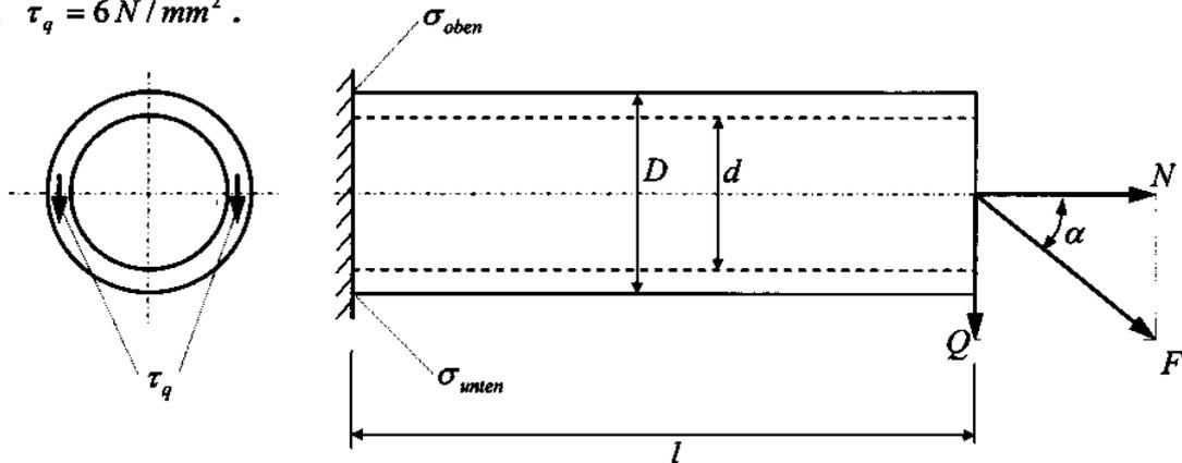
Bestimmen Sie die Normalkraft  $N$ , das Biegemoment  $M_b$  an der Einspannstelle, die Querkraft  $Q$  und den Hebelarm  $l$ !
