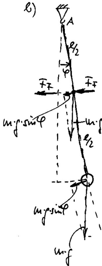
$$J_A \cdot \ddot{\varphi} = -2 \cdot F_F \cdot \frac{l}{2} - \underbrace{m \cdot g \cdot \sin \varphi \cdot \frac{l}{2}}_{\approx \varphi} - \underbrace{m \cdot g \cdot \sin \varphi \cdot l}_{\approx \varphi}$$
