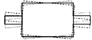
Zur maschinendynamischen Untersuchung dieser Taumelbewegung wird das Massenträgheitsmoment des Rotors benötigt. Die Massenwirkung der Punktmassen kann hierbei zunächst vernachlässigt werden. Berücksichtigt werden soll die dicke Rotorwelle (Durchmesser 100 mm) sowie die beiden Wellenzapfen (Durchmesser 25 mm). Die Dichte beträgt  $7850 \text{ kg/m}^3$ .
