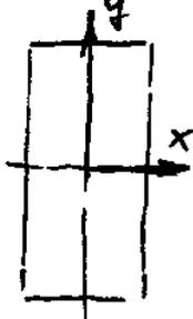
$$\sigma(x,y) = 10 \frac{\text{N}}{\text{mm}^2} + \frac{10000 \text{ N} \cdot 10 \text{ mm}}{\frac{1}{12} \cdot 50 \cdot 20^3 \text{ mm}^4} \cdot x - \frac{10000 \text{ N} \cdot 25 \text{ mm}}{\frac{1}{12} \cdot 20 \cdot 50^3 \text{ mm}^4} \cdot y$$
