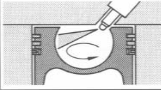
Brennraumform und Düsenanordnung für das MAN-M-Verfahren.
