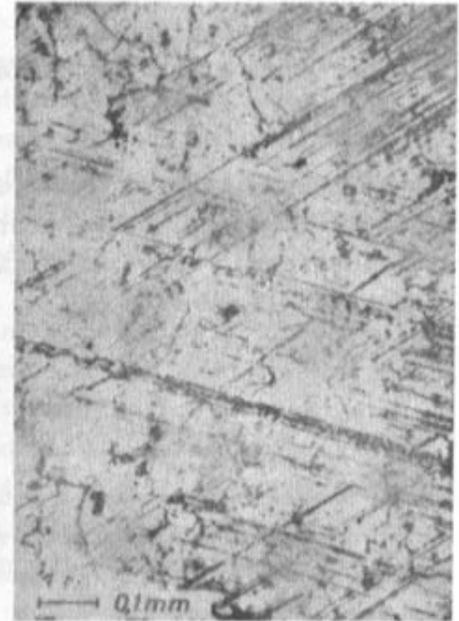
Honbild eines Zylinderrohres (vergrößert)
