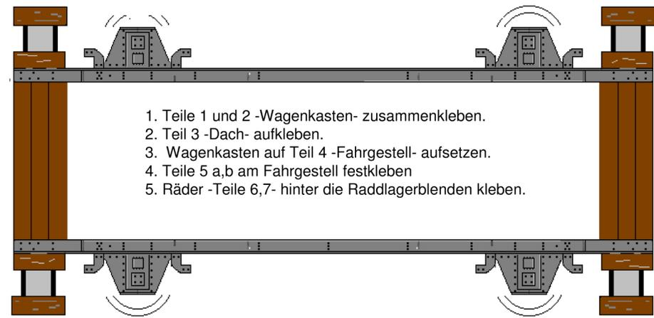
1. Teile 1 und 2 -Wagenkasten- zusammenkleben.
