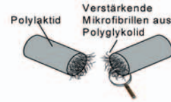
Abb. 2: Konventioneller Knochennagel (vorne), MFC-Knochennagel (hinten).
