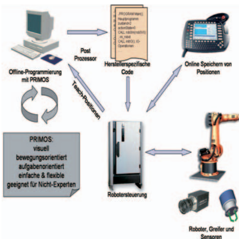
Abb. 2: Interne Architektur von PRIMOS: Zur Programmerstellung werden in PRIMOS gespeicherte Positionsdaten eingelesen. Nach Abschluss des Programmierens wird herstellerspezifischer Code erzeugt und zur Ausführung auf die Robotersteuerung geladen.
