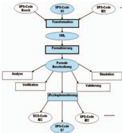
Abb. 1: Vorgehensmodell für das Re-Engineering von Steuerungsprogrammen. Im Bild ist exemplarisch der Weg von einer SPS vom Typ S5 zu einer SPS vom Typ S7 hervorgehoben.
