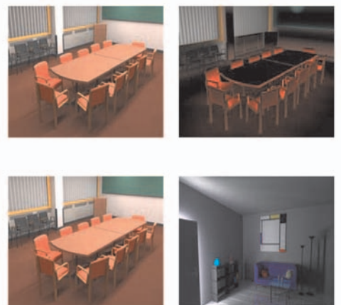
Abb. 2: Bild. a), erzeugt durch klassische Algorithmen, ist in Regionen konkaver Geometrie, zum Beispiel bei den Vorhängen und Stuhlsitzflächen, deutlich zu dunkel. Dies zeigt das Differenz Bild b) zur physikalisch korrekten Lösung c). In d) wird ein Zimmer durch einen Türspalt beleuchtet. Diese Situation ist mathematisch besonders schwierig.
