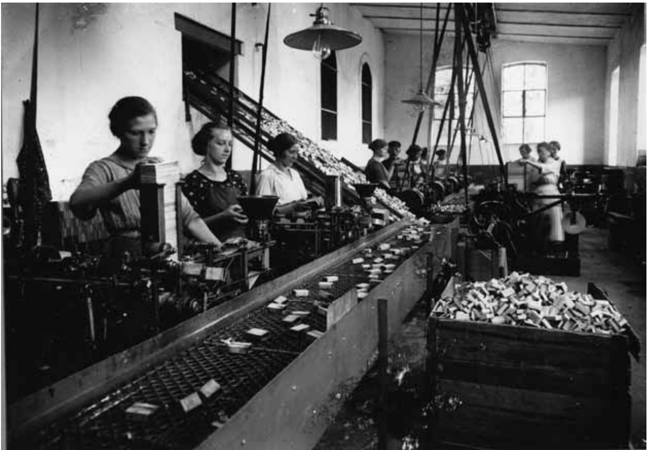
Zündholzfabrik Benedick in Albersweiler, hier: die Klebmaschinen für die Außen- und Innenschachteln. Das Transportband führt zu den Schachteln- und Trockenautomaten. 1924
