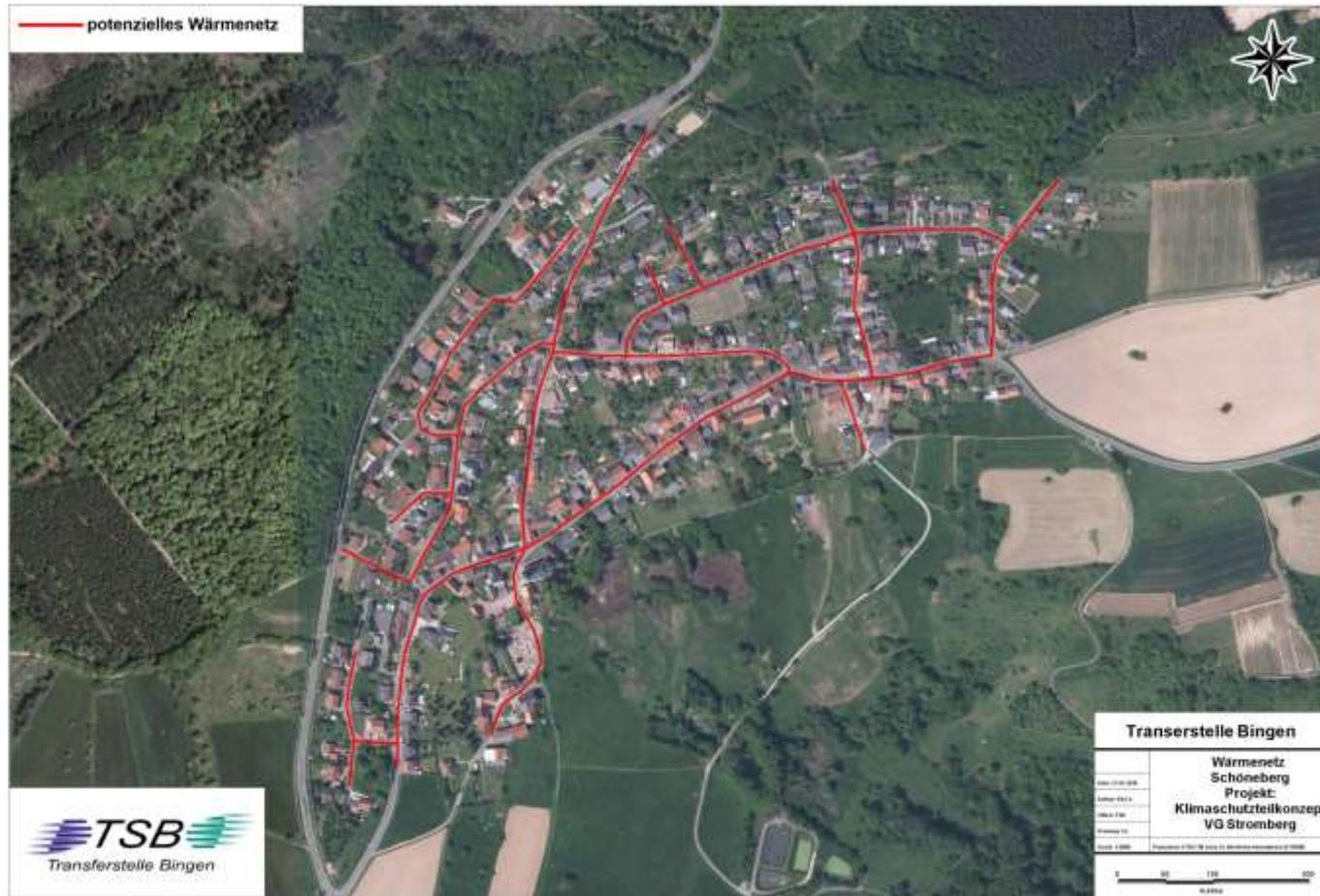
Rohrnetzkenzahl:  $1016 \text{ kWh}_{\text{th}}/\text{m}_{\text{Trasse}} \cdot \text{a}$
