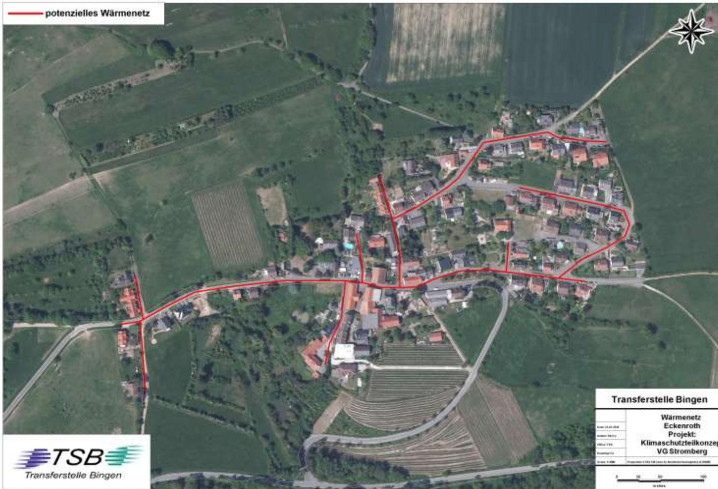
Rohrnetzkenzahl:  $982 \text{ kWh}_{\text{th}}/\text{m}_{\text{Trasse}} \cdot \text{a}$
