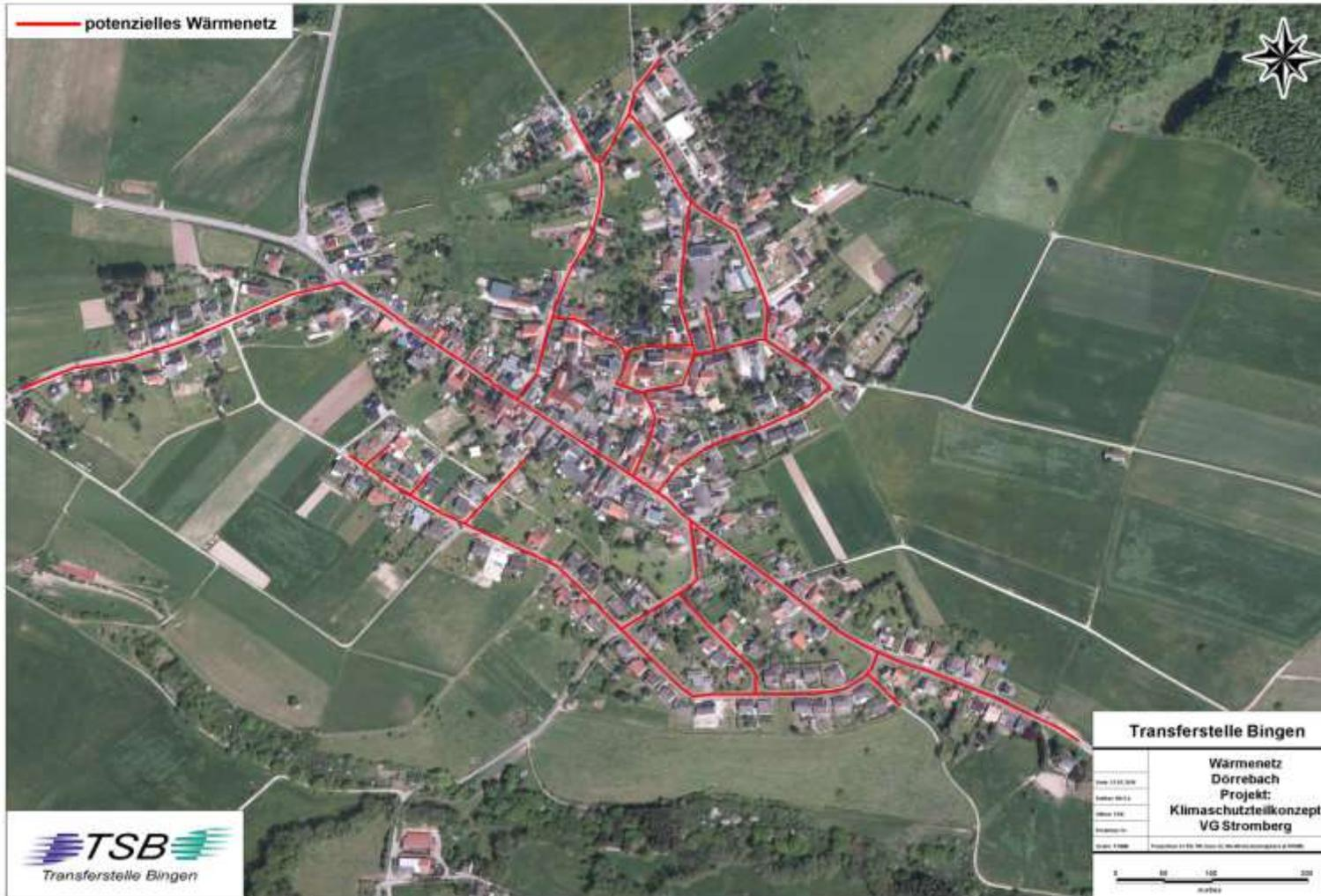
Rohrnetzkenzahl:  $966 \text{ kWh}_{\text{th}}/\text{m}_{\text{Trasse}} \cdot \text{a}$
