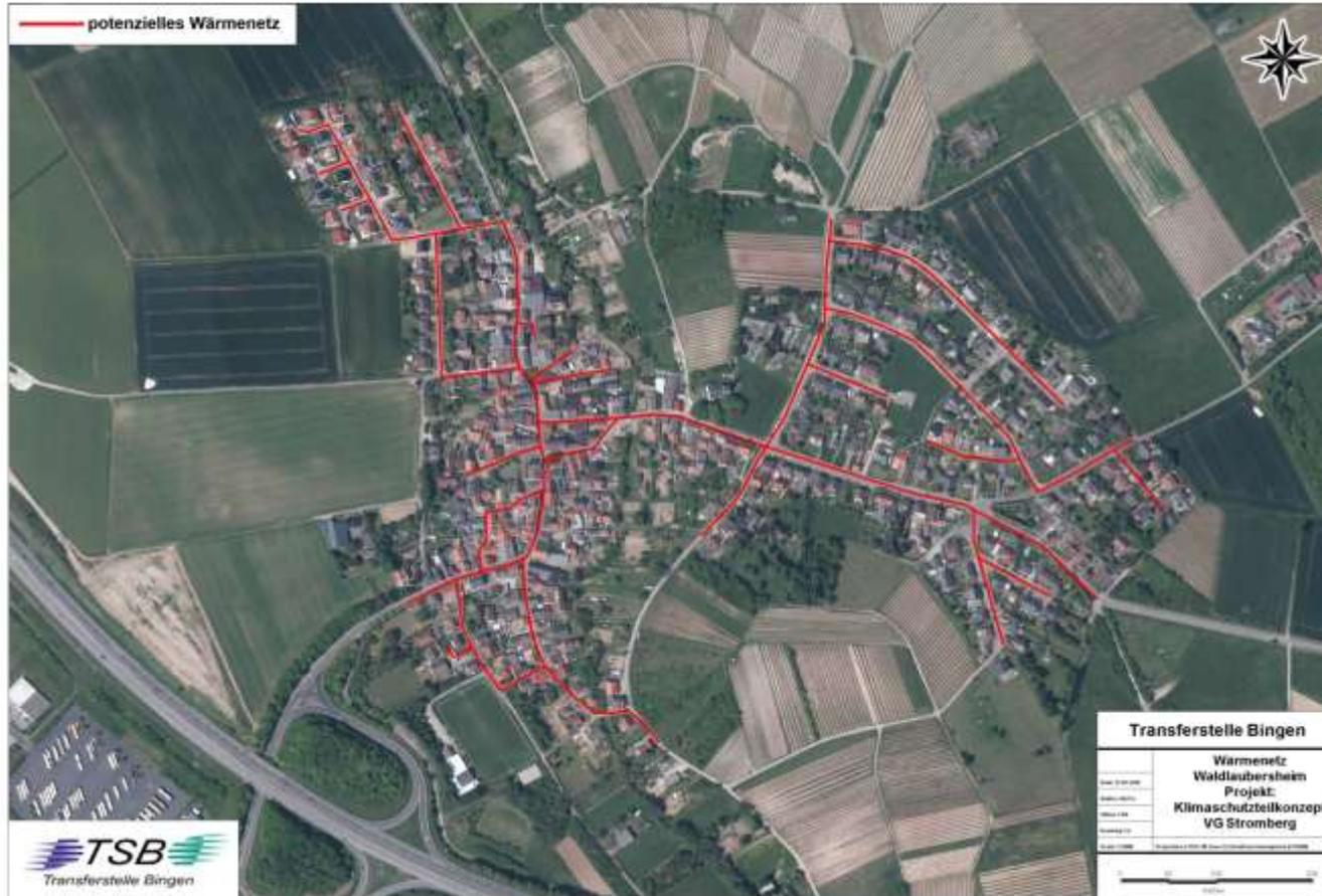
Rohrnetzkenzahl:  $940 \text{ kWh}_{\text{th}}/\text{m}_{\text{Trasse}} \cdot \text{a}$
