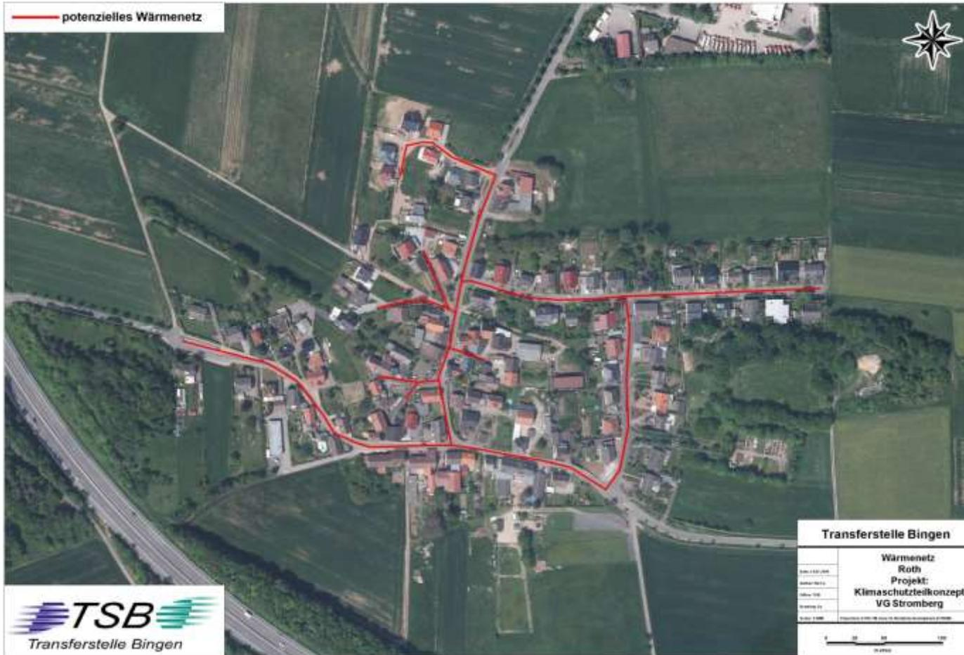
Rohrnetzkenzahl:  $998 \text{ kWh}_{\text{th}}/\text{m}_{\text{Trasse}} \cdot \text{a}$
