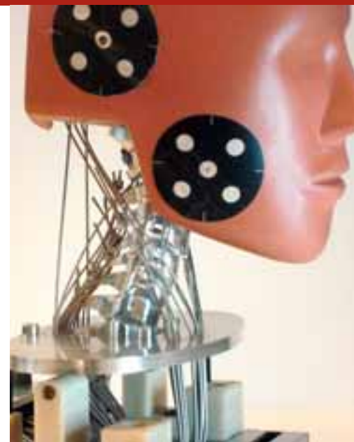
Abb. 2: An der Fachhochschule Kaiserslautern aus Aluminium durch 5-Achs-Simultanfräsen hergestellte Wirbelsäule
