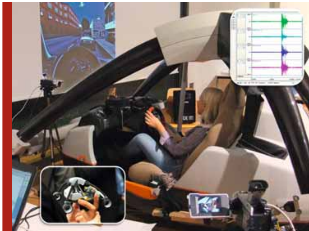
Abb. 5: Versuchsanordnung: Die Projektion der Fahrsimulation ist mutwillig etwas nach rechts versetzt worden, um mit der Frontkamera festzustellen, ob das gewählte, akustische Signal die gewünschte Ausrichtung des Kopfes zum Head-Up-Display bewirkt. Die untere Einblendung zeigt das Gesamtversuchsfahrzeug als funktionsfähiges Modell. Die obere Einblendung zeigt die Aktivierung der Halsmuskeln beim Schrecksignal.
