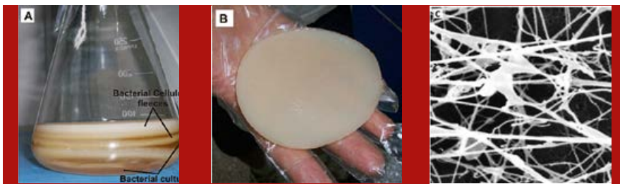
Abbildung 2 a: Bakterien-Cellulose für Wundauflagen: A: Kulturgefäß B: Vlies C: REM-Aufnahme von Nano-Fasern. (Fotos: Natalie Geisel)
