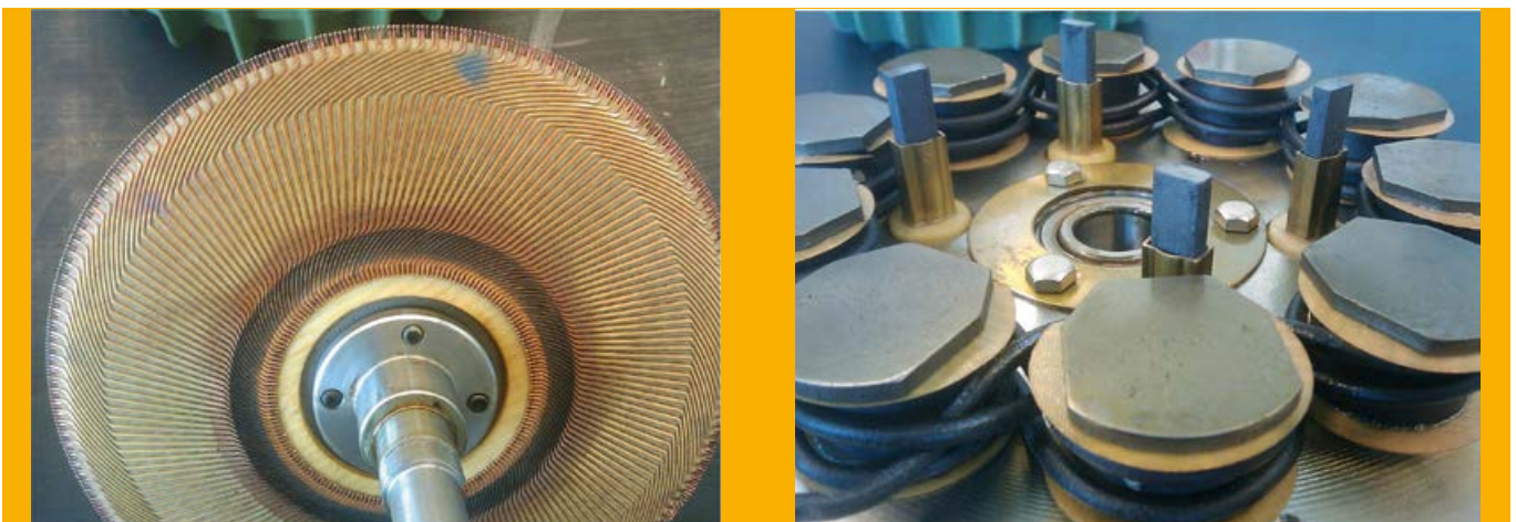
Abbildung 1: Klassischer Gleichstromservomotor in Scheibenläuferbauweise (links: Rotor, rechts: Stator)
