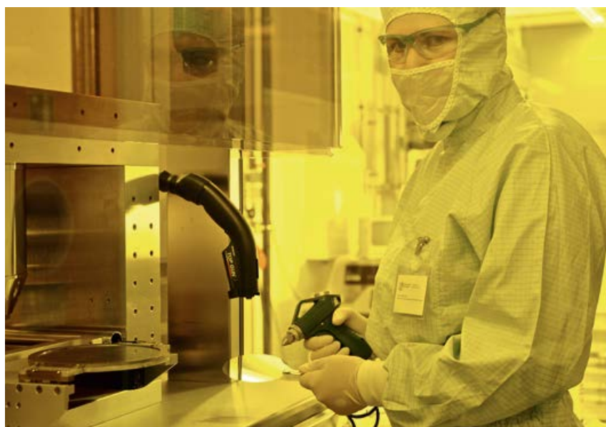
Um sicherzugehen, dass kein Staubpartikel stört, wird selbst im Reinraum immer wieder gereinigt.
