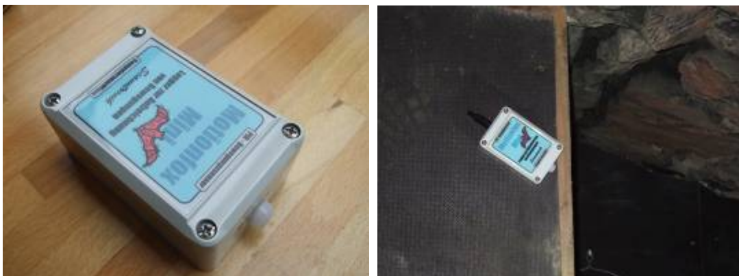
Abbildung 16: Der Motionfox-Mini ist ein Datenlogger zur Aufzeichnung von Bewegungen, der speziell für Fledermäuse entwickelt wurde. Rechts im Einsatz in einem Winterquartier in einer Tunnel-Zwischendecke.
