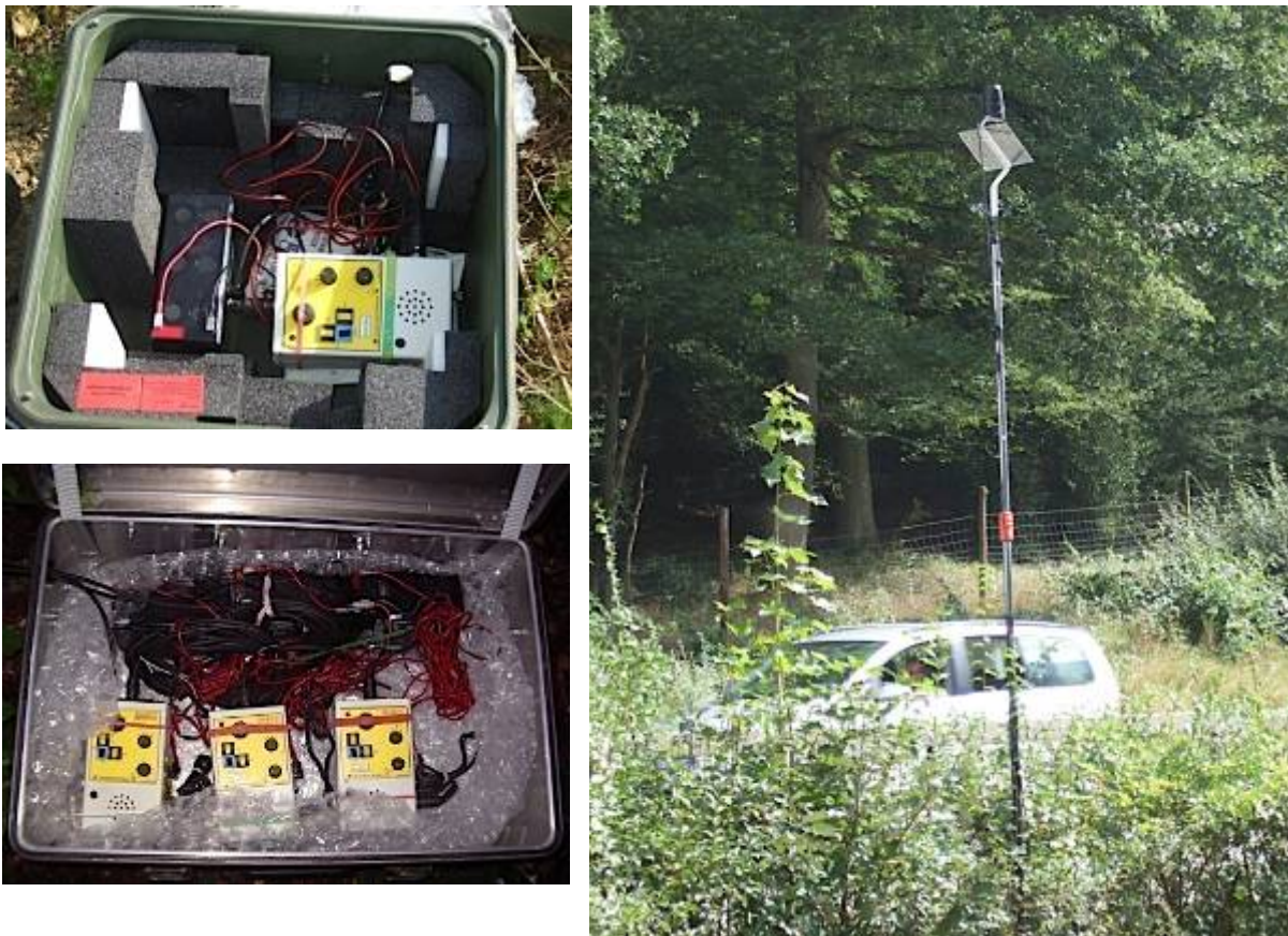
Abbildung 7: Anabat II mit Stromversorgung im Geländeeinsatz.
