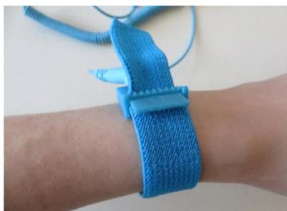
Die Person, die später die Tasten bedient, zieht das Armband an und befestigt die dazugehörige Krokodilklemme an der Erdung (**EARTH**). Alternativ kann hier auch ein Armband aus Alufolie gebastelt werden, welches mit einer Krokodilklemme mit der Erdung verbunden wird.
