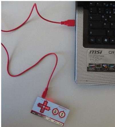
Die Platine bietet auf der Oberseite 4 Pfeiltasten (**Steuerkreuz**), eine Leertaste (**SPACE**) und eine Taste, die der linken Maustaste entspricht (**CLICK**). Das Board wird mit einem USB-Kabel an einen PC oder ein Laptop angeschlossen. Wenn es betriebsbereit ist, leuchtet auf der Unterseite eine rote LED.
