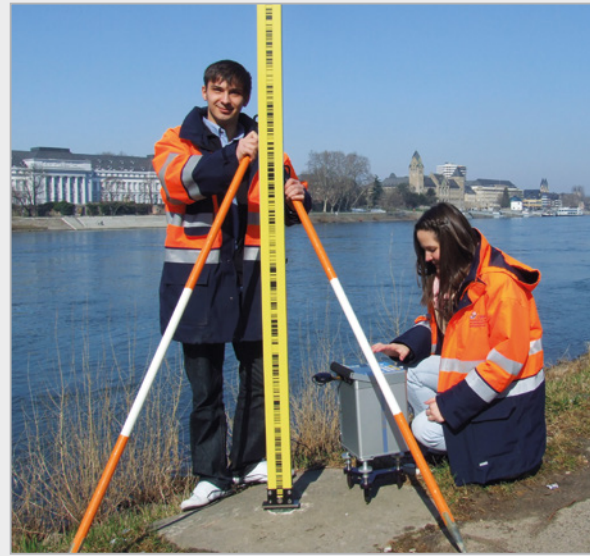
Höhenbestimmung durch Nivellement und Schweremessung
