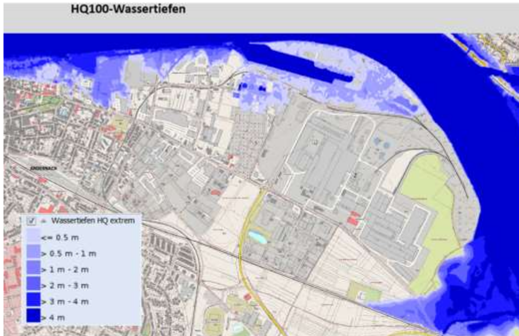
Abbildung 21: HQ 100 -Überflutung im Gewerbegebiet
