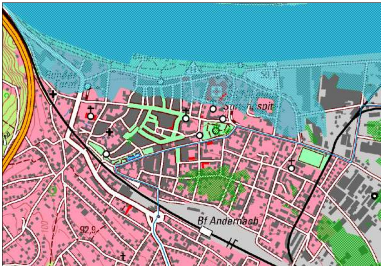
Abbildung 2: Überflutungsfläche bei HQ100 im Rhein
