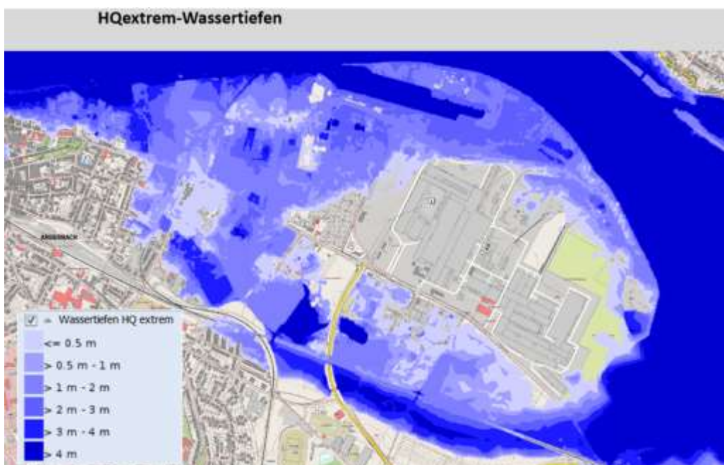
Abbildung 22: HQ extrem -Überflutung im Gewerbegebiet
