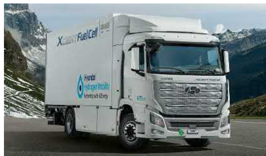
Abbildung 50: Hyundai Xcient Fuel Cell: erster Serien-Wasserstoff-Brennstoffzellen-Schwerlast-Lkw
