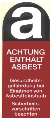
Kennzeichnung asbesthaltiger Abfälle
