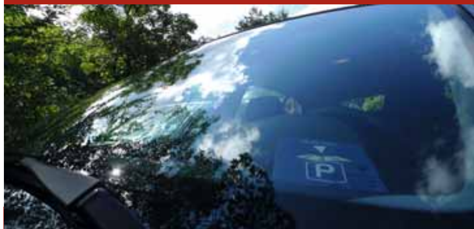
Abb. 2: Der Fresnel-Effekt als Beispiel für die Winkelabhängigkeit des Reflexionsverhaltens von Oberflächen (Bildquelle: Stefan Häfner)
