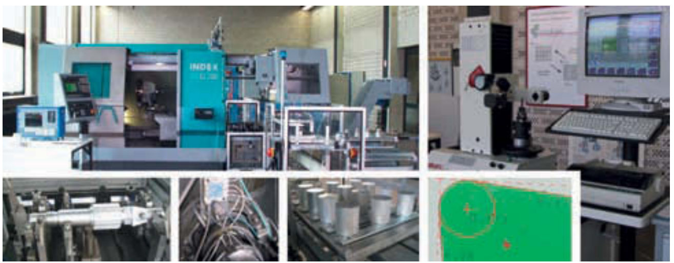
Flexible Fertigungszelle Index G200, Drehen + Fräsen mit 5 NC-Achsen, Handhabungsroboter, Rohteilpaletten, Messstation, Schwingungsmessung und Werkzeugvoreinstellgerät
