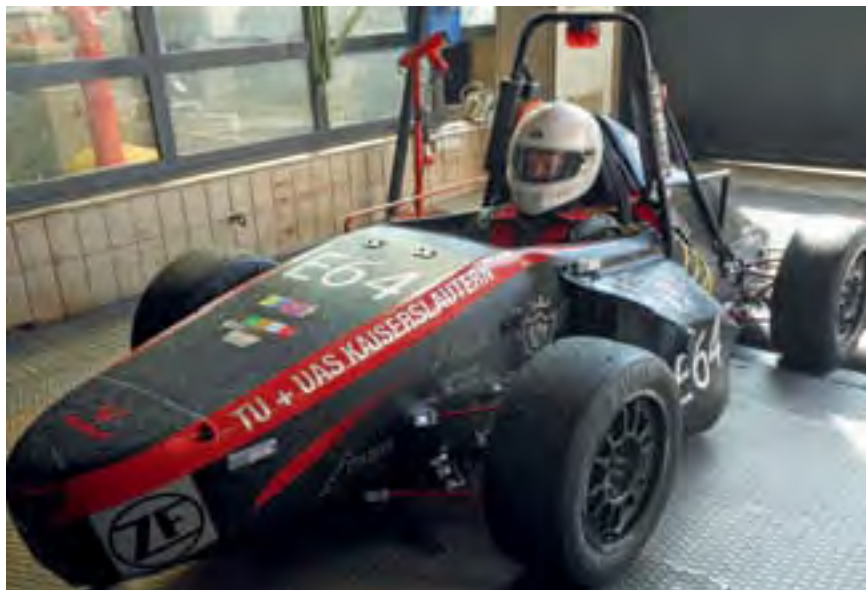
Statischer Freigängigkeitstest mit dem Electronyte I 2 auf dem Rollenprüfstand (Fabian Giehl), Foto: Heidrich
