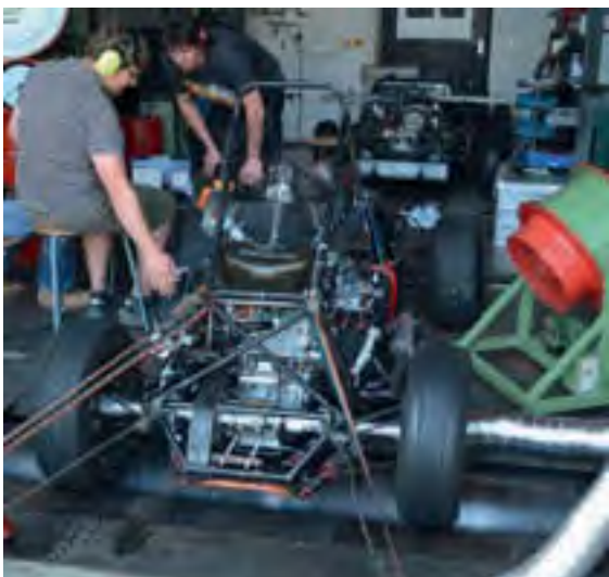
Abstimmung des Steuergerätes auf die neue Abgasanlage des Carbynite I I (David Woike, links, und Fabian Reuter, rechts), Foto: KaRaT
