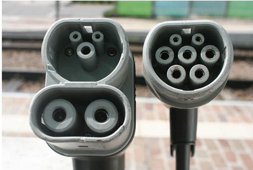
Abbildung 4 Bild eines CCS-Steckers (links) und eines Typ-2-Steckers (rechts)
